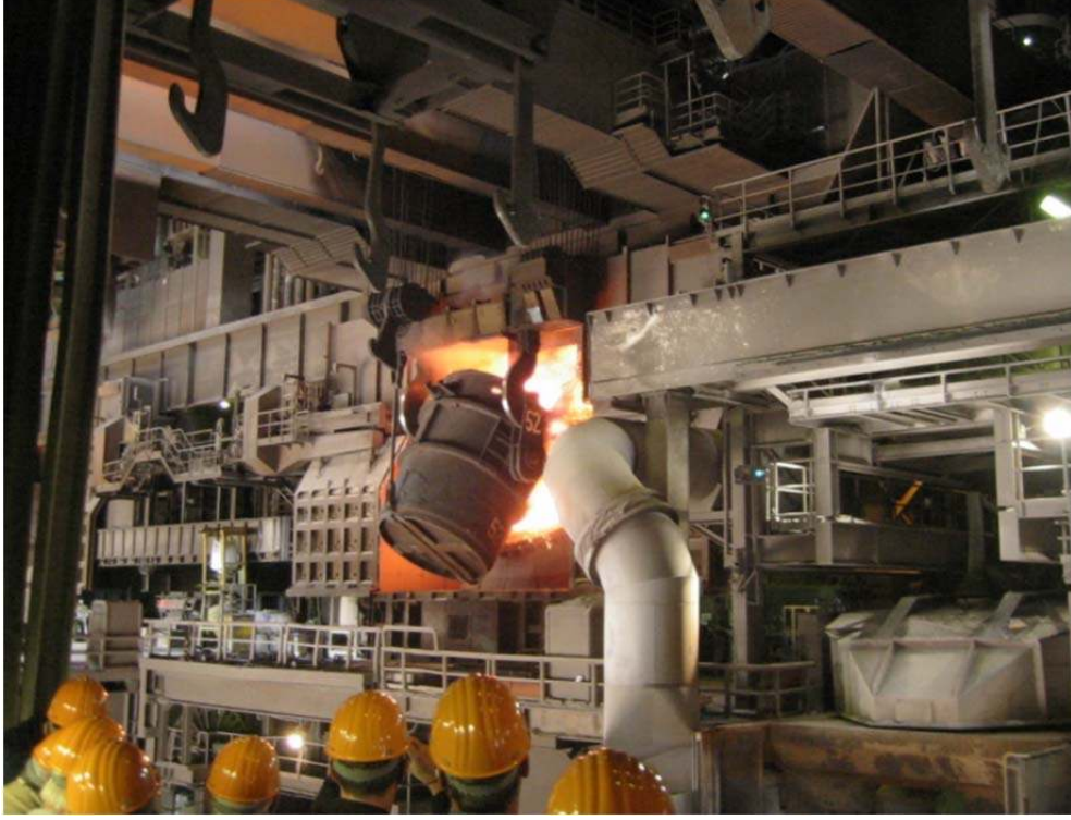
Şekil 1.3. Bazik oksijen fırınları (BOF) ile sıvı ham demirden çelik üretimi
