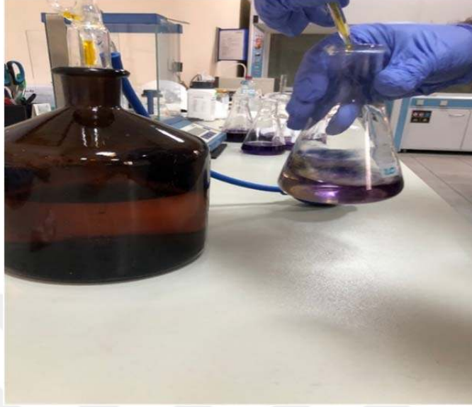
Şekil 3. 16. K_2Cr_2O_7 titrantı ile numunelerin titrasyon işlemi
