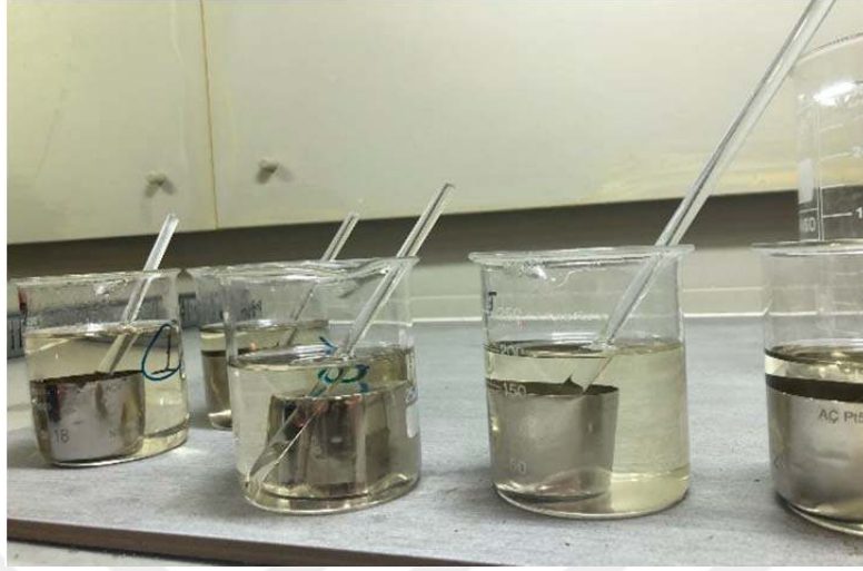
Şekil 3.13. Eritişi yapılan cürufların asitte çözünmesi
