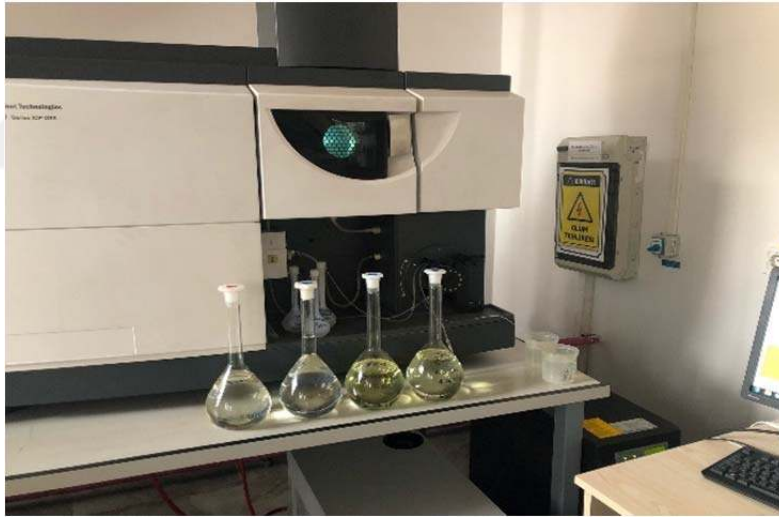
Şekil 3.14. Hazırlanan cürufların ICP-OES’de okunması
