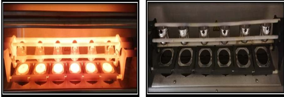
Şekil 3. 11. Eritiş Cihazı iç haznesi
