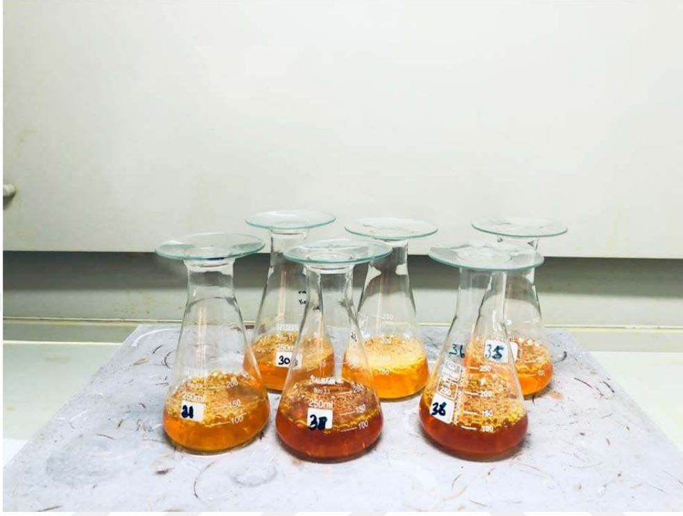
Şekil 3.15. FeO tayini için numunelerin HCl ile çözünmesi
