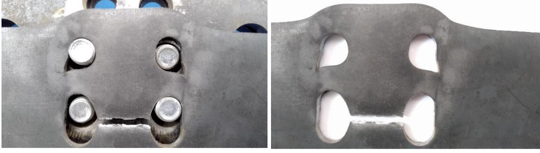
Şekil 5.31. 1 nolu noktada T2B deney numunesindeki hasar durumu
