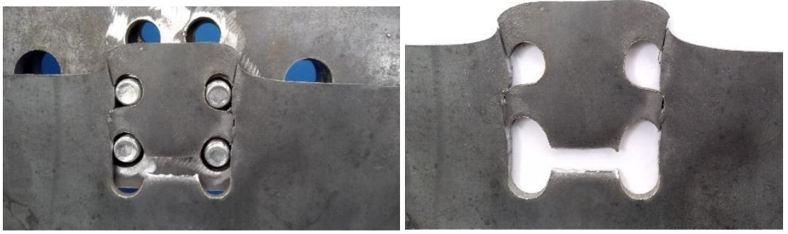
Şekil 5.28. 2 nolu noktada T2A deney numunesindeki hasar durumu
