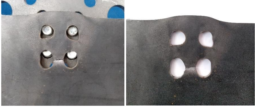
Şekil 5.19. 1 nolu noktada T1B deney numunesindeki hasar durumu
