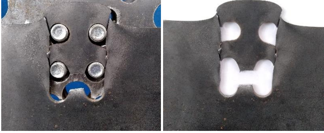
Şekil 5.20. 2 nolu noktada T1B deney numunesindeki hasar durumu
