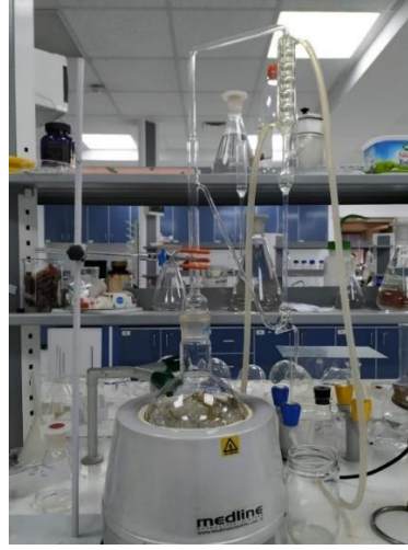
Şekil 3.2. C. mucronifera bitkisel materyalinin Clevenger apareyinde hidrodistilasyonu
