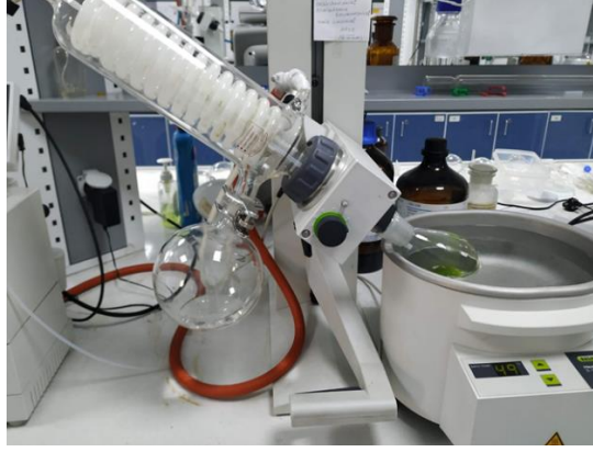
Şekil 3.5. C. mucronifera sıvı ekstrelerinin döner buharlaştırıcıda yoğunlaştırılması
