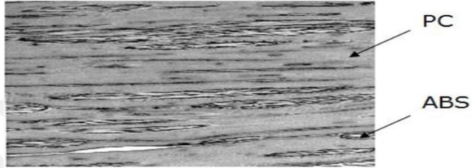
Şekil 4.4 PC/ABS harman yapısı (Resinex, 2018)
