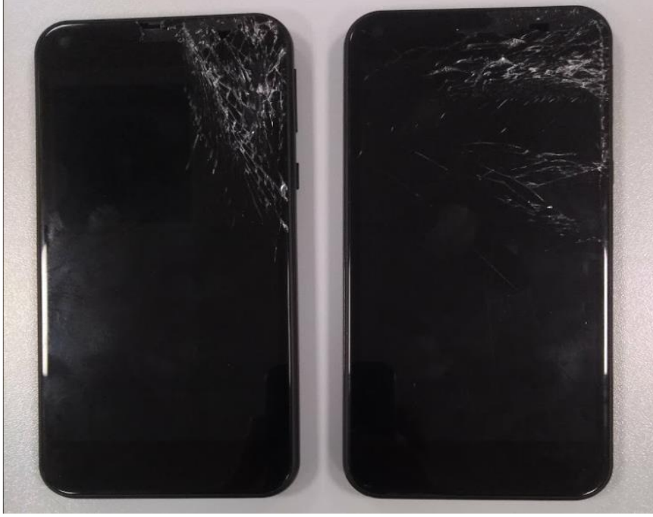
Şekil 4.31 Cep telefonunun 2250 mm'den yüzey atışı sonrası camdaki hasar (Kişisel arşiv, 2018)
