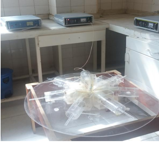
Resim 1: RF sinyal Jeneratörleri ve Deney Düzeneği
