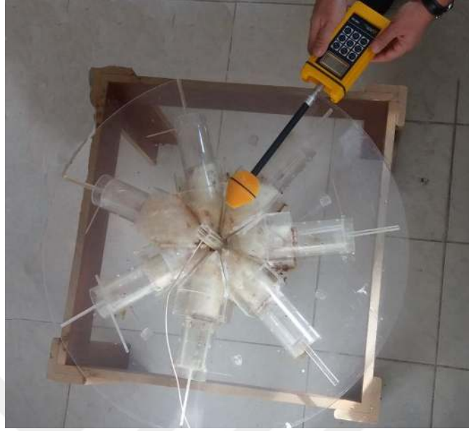
Resim 8: NARDA EMR 300 cihazı ile ölçüm alınması
