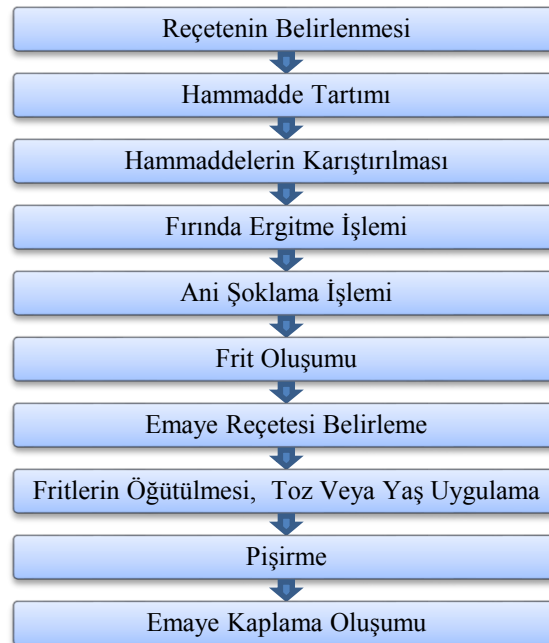
Şekil 3.2. Emaye kaplama oluşum aşamaları.
