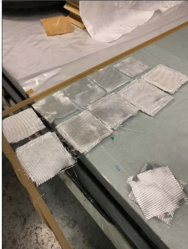
Şekil 4.23. Numunelerin imalatı için kumaşların hazırlanması
