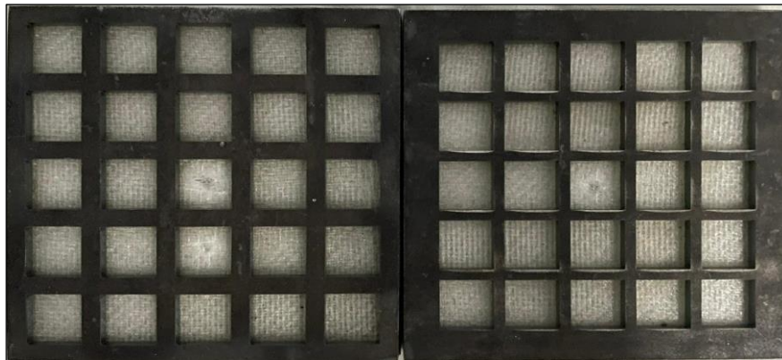
Şekil 4.63. 25 kareli 3 ve 5 mm cidar kalınlığına sahip çerçeve destekli kompozit numunede darbe sonrası görüntüsü
