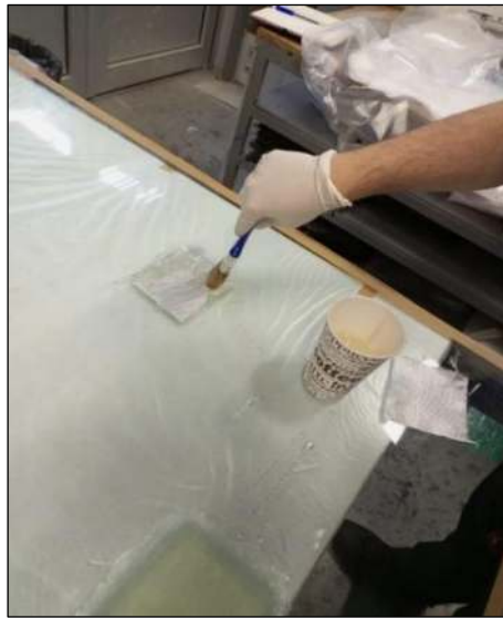
Şekil 4.25. Kompozit numunelerin imalatında kullanılan reçinenin takviye malzemesine uygulanışı
