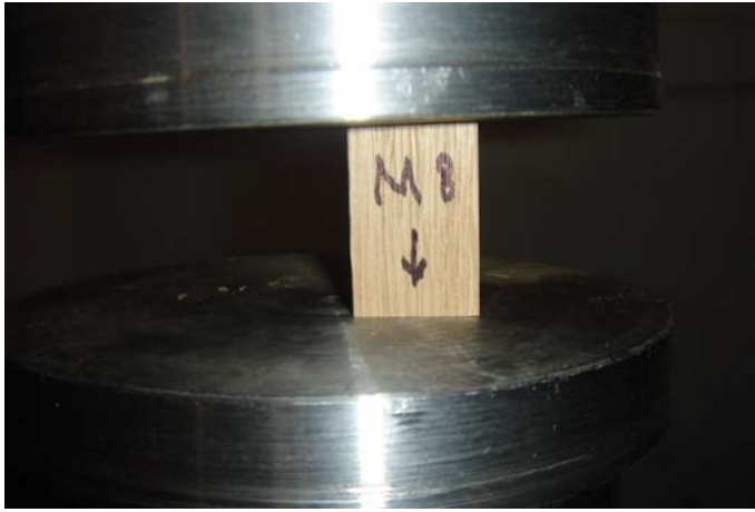
Resim 4.2. Basınç direnci deneyi örneği
