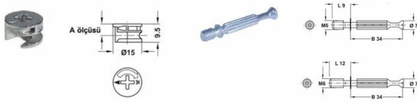
Şekil 4.3. Deney numunelerinde kullanılan minifiks bağlantı elemanı
