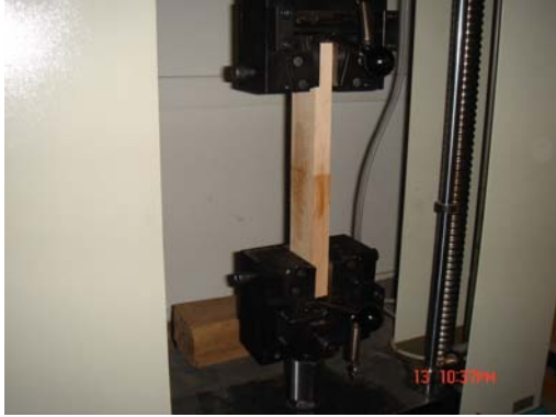
Resim 4.7. I-tipi boyuna çekme örneklerinde deney düzeneği ve yük uygulama biçimi
