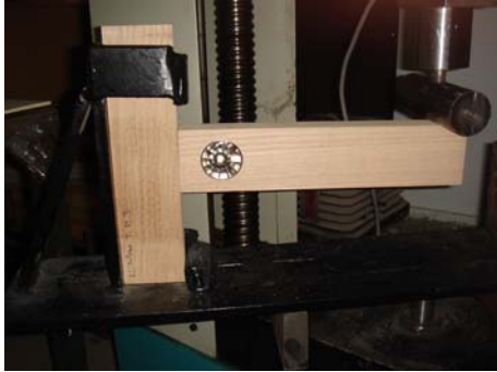
Resim 4.11. T-tipi moment kapasitesi deney düzeneği ve yük uygulama biçimi
