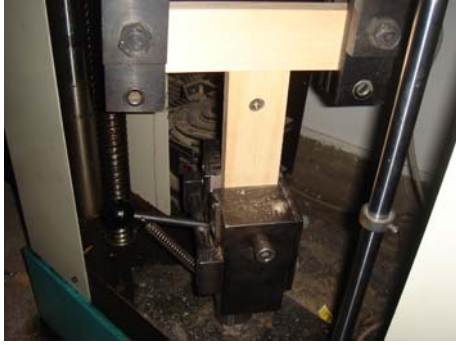
Resim 4.10. T-tipi çekme deney düzeneği ve yük uygulama biçimi
