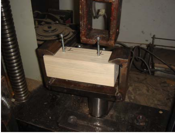
Resim 4.6. Vida çekme deneyi düzeneği
