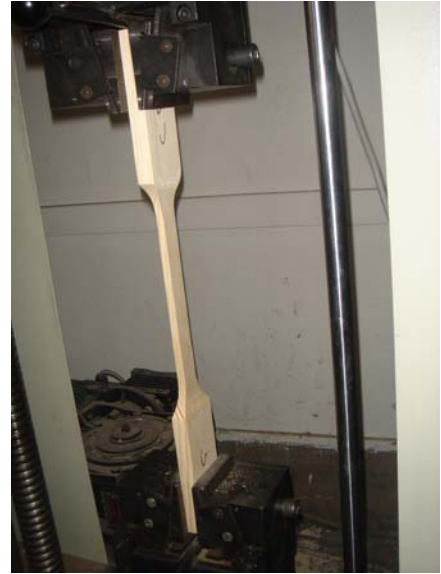
Şekil 4.5. Masif ağaç malzeme için çekme deneyi örnekleri (ölçüler mm’dir)
