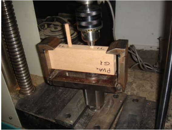
Resim 4.5. Kavela çekme direnci deney örneği ve test düzeneği
