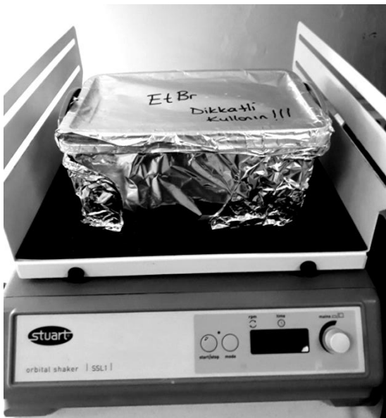
Şekil 1.18. Agarose jelin ethidium bromür ile boyanması
