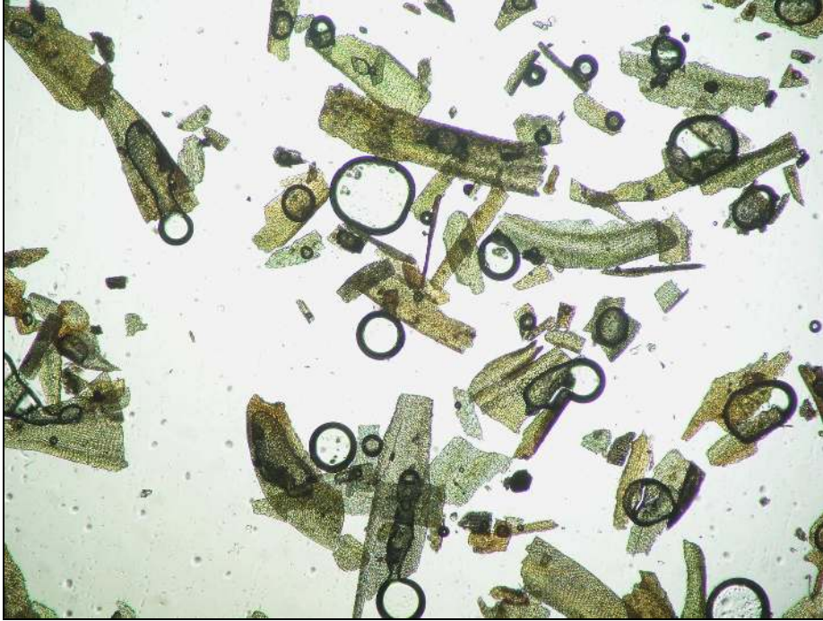
Şekil 3.5. L. sciuroides 140 \mu\text{m} elekten geçen parçaların mikroskop görüntüsü (Şekillerdeki yuvarlak alanlar hava kabarcıklarıdır)
