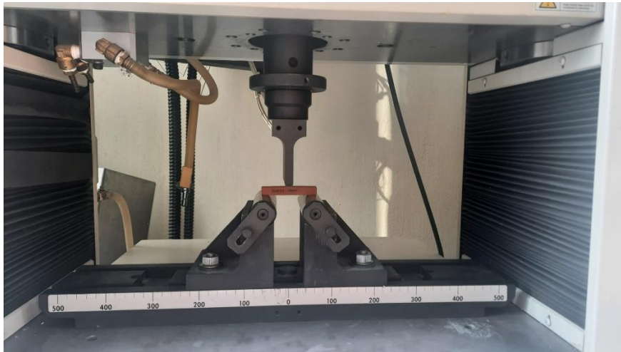
Resim 3.5 3 Nokta eğme test düzeneği.
