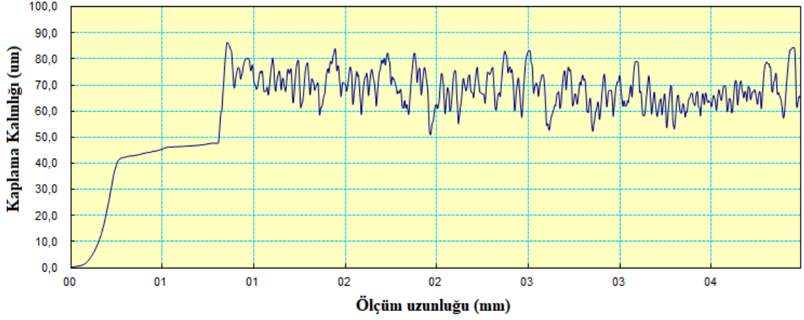
Şekil 3.50. T1N kodlu çözeltide gerçekleşen çinko kaplamanın kalınlık sonuçları
