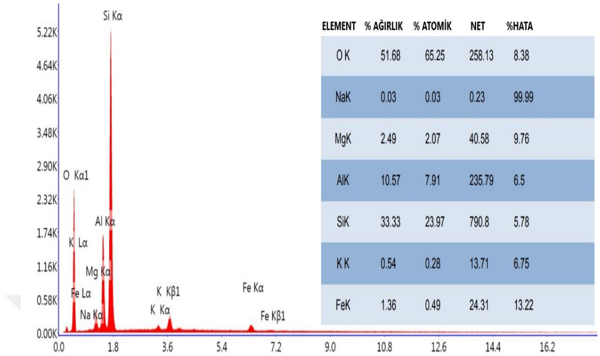
Şekil 5.4. Saf Bentonit'in EDX değerleri
