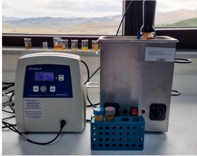
Şekil 4. Sonikasyon işlemi için kullanılan Problu Ultrasonik Homojenizatör (Sonoplus Mini20) cihazı
