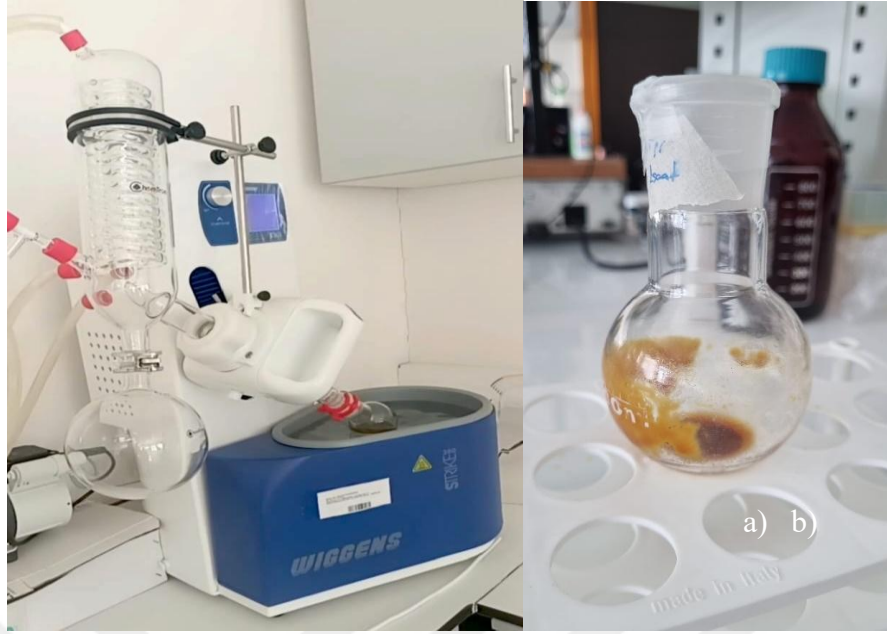
Şekil 6. a) Evaporatör cihazında propolis çözeltisinden etanollerin uzaklaştırılması işlemi. b) Uzaklaştırılan etanol sonrası elde edilen propolis özütü örneği
