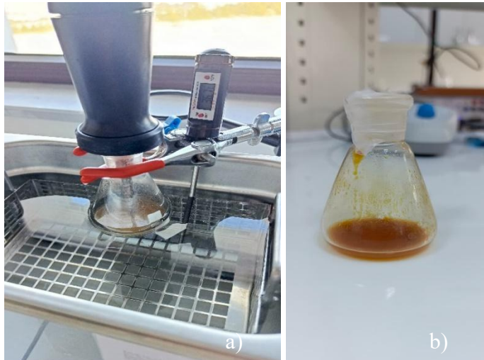
Şekil 5. a) Propolis çözeltisinin sonikasyonu b) Sonikasyon işleminden sonra elde edilen propolis çözeltisi
