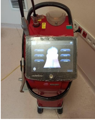
Şekil 3.3.1 C) Çalışmada kullanılan Er,Cr:YSGG lazer
