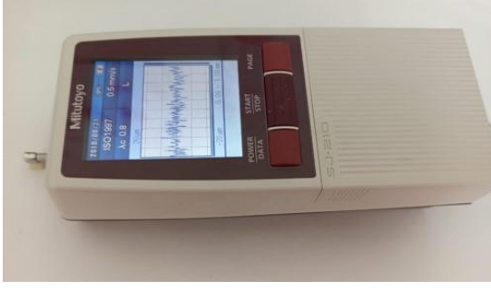
Şekil 3.2.2. Çalışmada kullanılan profilometre cihazı ile yüzey pürüzlülüklerinin ölçülmesi
