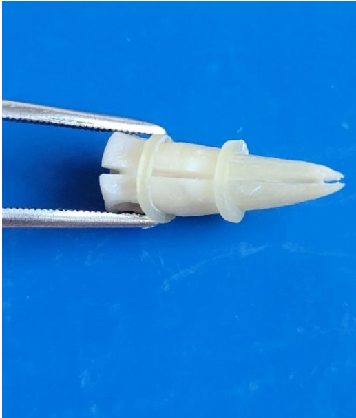
Şekil 3.19. Ortodontik lastik geçirilmiş ve pembe mumla kaplanmış örnek
