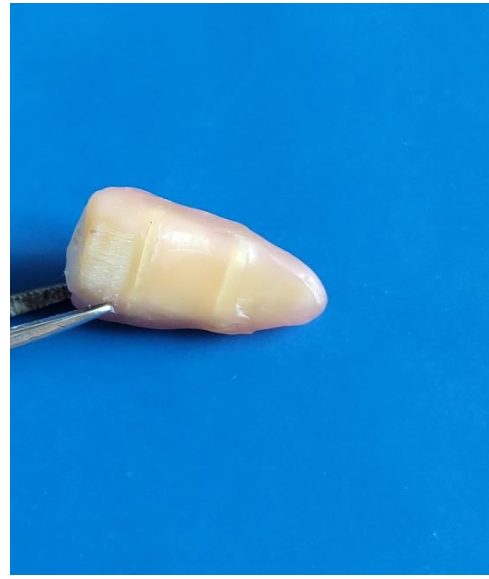
Şekil 3.15. Ortodontik lastik geçirilmiş ve pembe mumla kaplanmış örnek
