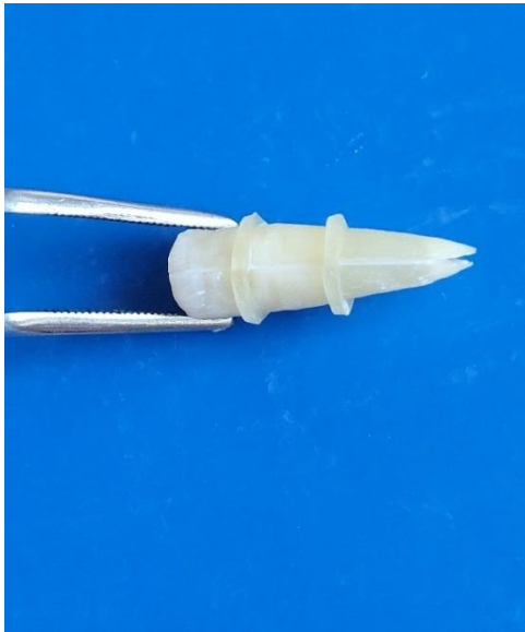
Şekil 3.15. Ortodontik lastik geçirilmiş ve pembe mumla kaplanmış örnek
