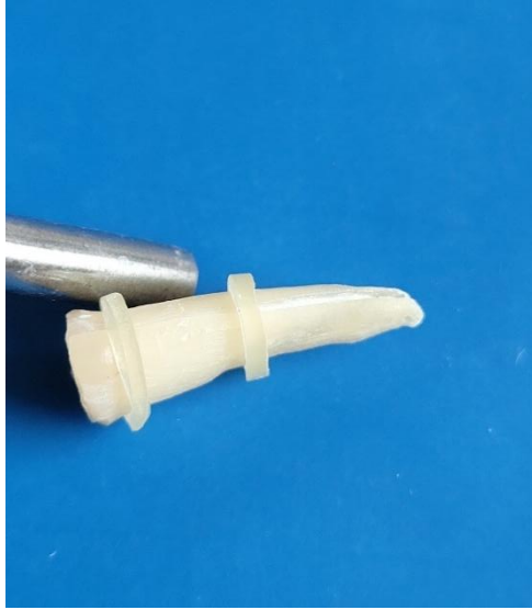
Şekil 3.27. Ortodontik lastik geçirilmiş ve pembe mumla kaplanmış örnek
