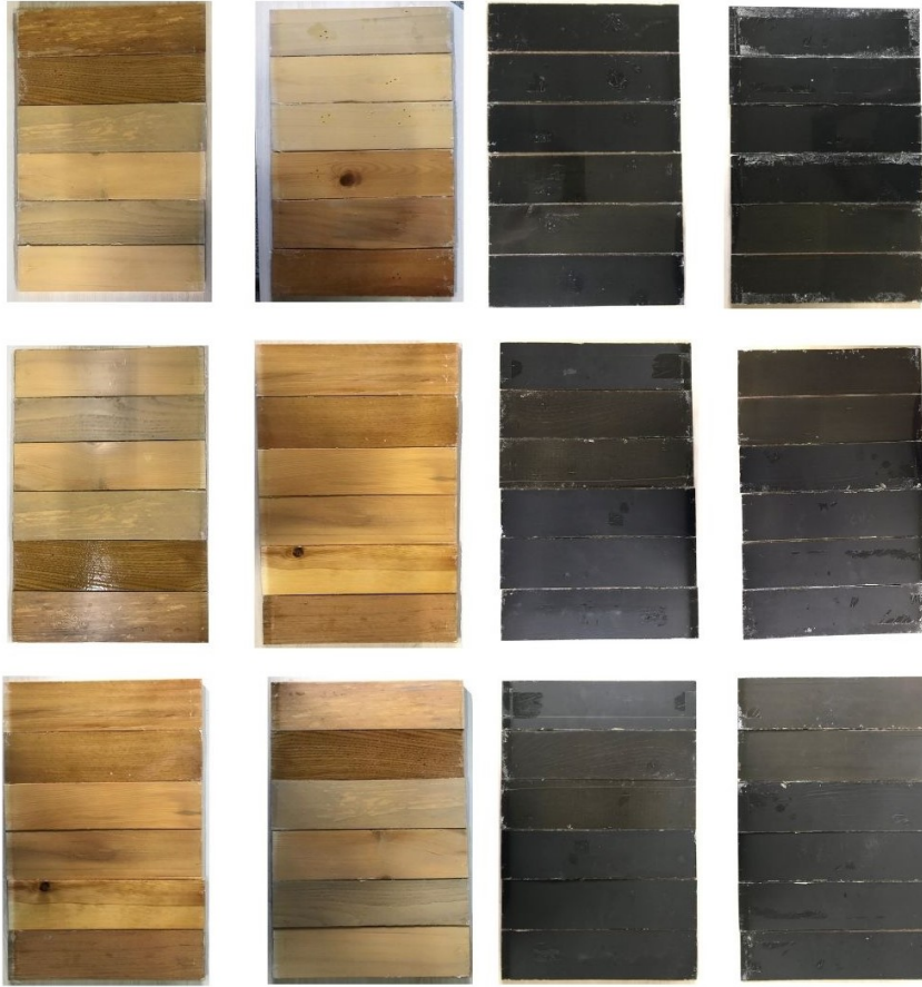
Şekil 8. Radyal kesitte poliüretan vernik katkı maddeli 0-200-400-600 saatlik deney örnekleri (foto Bozdoğan Balçık, Çakıcıer)
