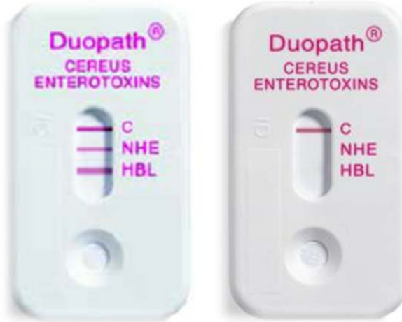
Şekil 3.9. Duopath cereus enterotoksin kitinde pozitif (sol) ve negatif (sağ) sonuç
