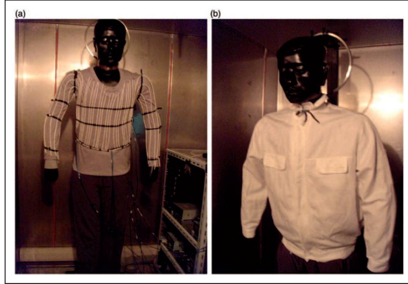
Şekil 1.62 Ke ve arkadaşlarının kullandığı termal manken sistemi: (a) Havalandırma oranının ölçüldüğü boru sistemine sahip termal manken, (b) Boyun ve etek kısmı kapatılmış ceket örneği (Ke ve ark., 2013)
