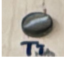
Şekil 2.7. 304L paslanmaz çelik üzerine sol-jel metoduyla titanyum kaplaması
