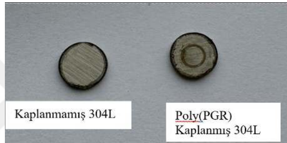
Şekil 2.1. Kaplama yapılmış ve yapılmamış 304L örnekleri
