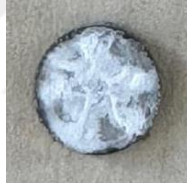
Şekil 2.8. 304L paslanmaz çelik üzerine sol-jel metoduyla zirkonyum kaplaması
