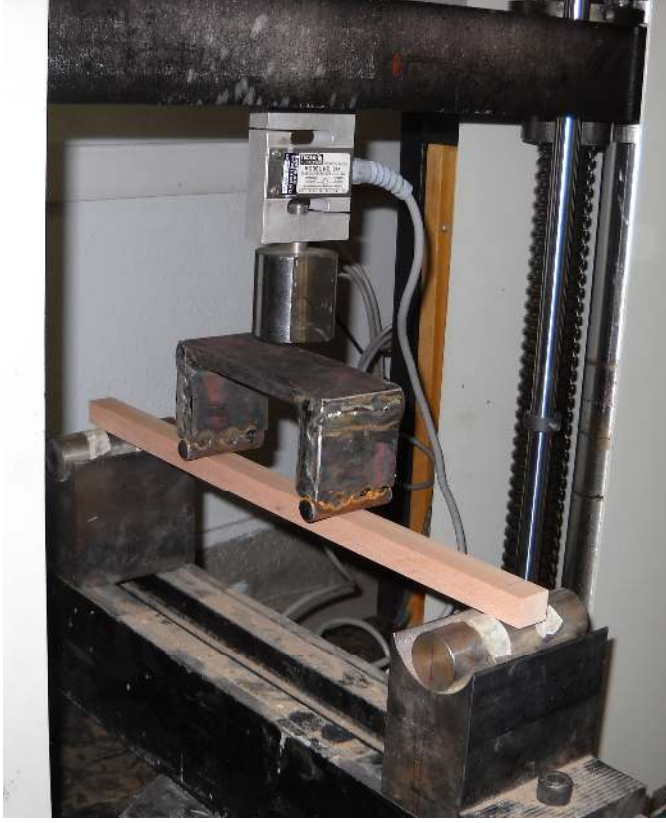
Resim 4.4. Eğilme direnci ve eğilmede elastikiyet modülü deney düzeneği
