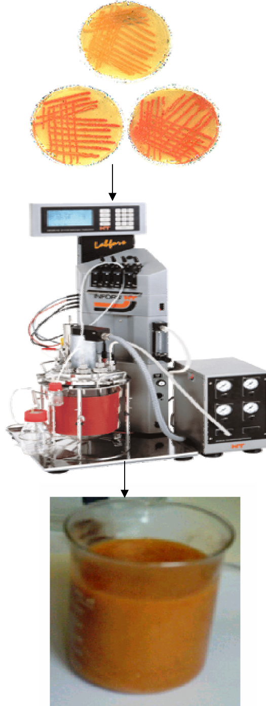
Resim 3.1.Mutant Mayanın Fermentörde Gelişimi
