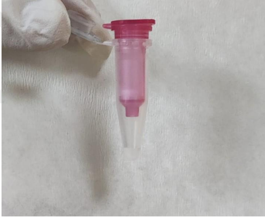
Şekil 3.2. RNA ekstraksiyonunda kullanılan silika bazlı mini spin kolon örneği
