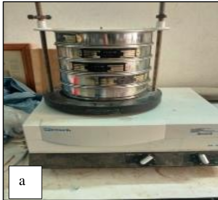
Fotoğraf 4.29 Willey değirmeninde öğütülen numunelerin titreşimli elekte elenmesi
