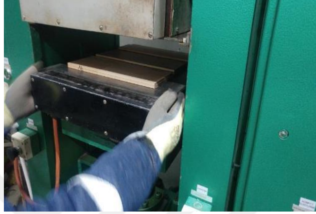
Fotoğraf 4.35 Tutkallı numunelerin Bürkle pres makinasında preslenmesi
