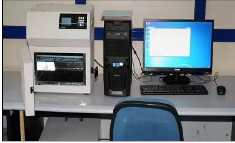
Fotoğraf 4.26 Thermtest HFM-100 Marka ısı geçirgenlik deneyi cihazı
