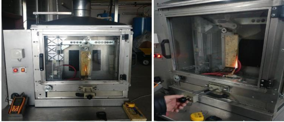
Fotođraf 4.21 ISO 11925-2 Yanma deneyi dzeneđi numune yzey ve kenar yanma uygulaması
