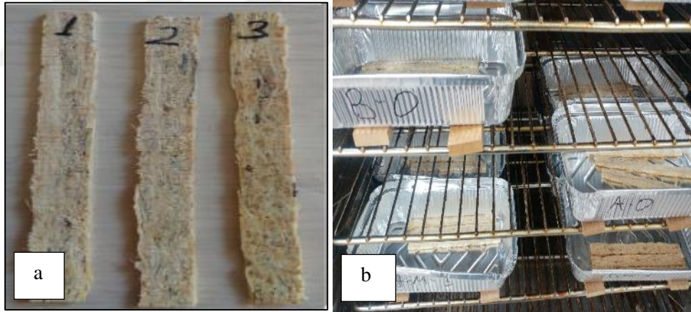
Fotoğraf 4.19 OSB numunelerinin yanma deneyi için hazırlanması (a) ve etüvde tam kuru hale getirilmesi (b)
