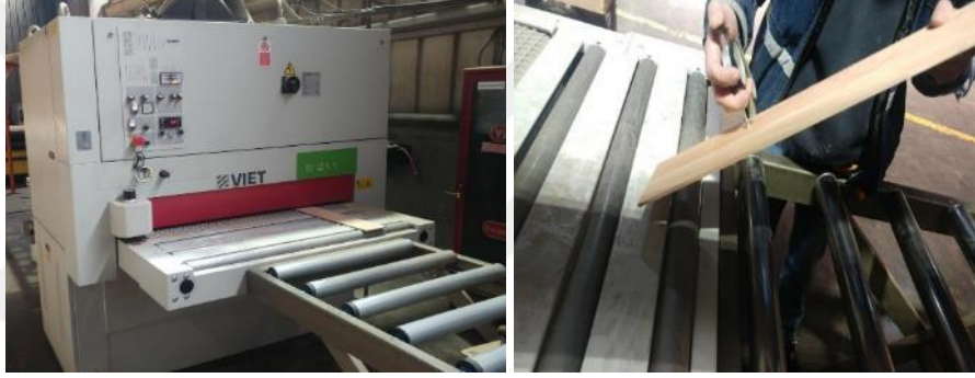
Fotoğraf 4.33 Kayın masif panelin zımparadan geçirilmesi
