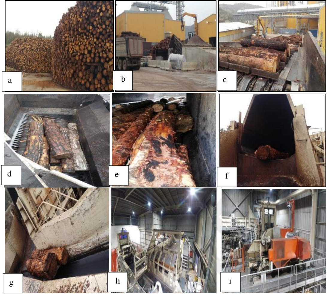
Fotoğraf 4.6 Odun istifi (a), odunların kabuk soyucuya taşınması (b, c), odunların kabuk soyucuda kabuklarının soyulması (d, e, f), odunların yongalayıcıya transferi (g), yongalayıcıda odunların yongalanması (h, i)
