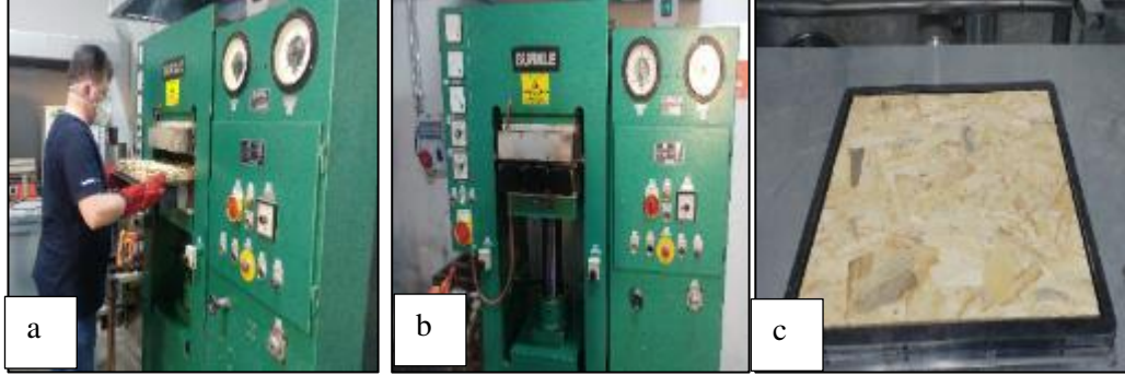
Fotoğraf 4.12 Flake pastasının prese sürülmesi (a), presleme (b), OSB levhasının oluşması (c)
