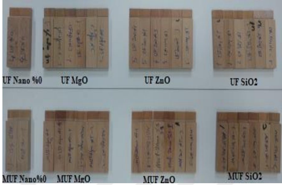
Fotoğraf 5.15 Çekme-Makaslama direnci deney numuneleri kopma şekilleri
