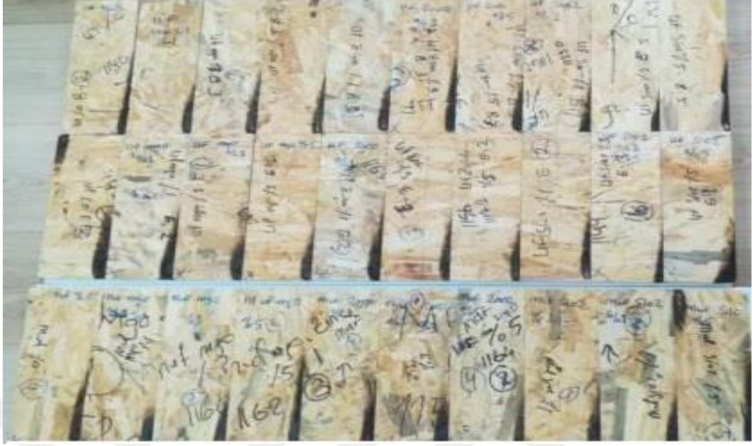
Fotoğraf 5.3 Yangına tepki deneyi kenarın aleve maruz bırakılması
