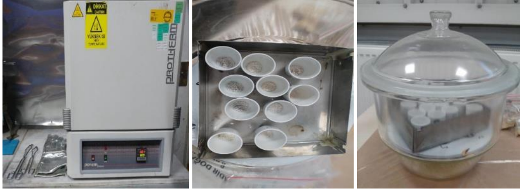
Fotoğraf 4.30 Kül testi fırın, krezeler, hassas terazi ve desikatör soğutma
