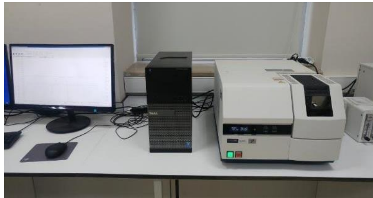
Fotoğraf 4.27 Hitachi marka, STA7300 model TGA+DTA cihazı
