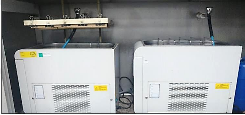
Fotoğraf 4.16 Kalınlık şişme deneyi Nüve BS 30 şişme havuzu
