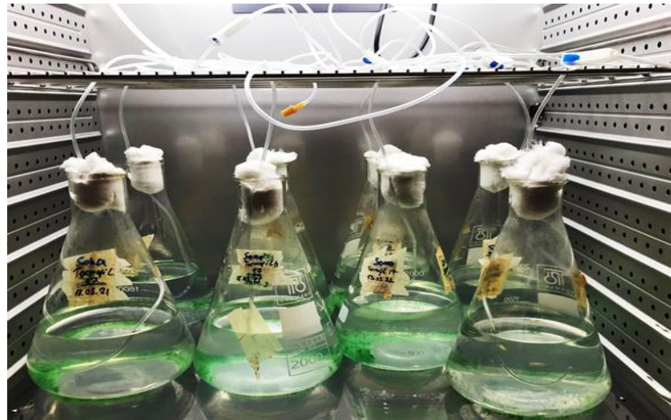
Görsel 2.2. Termofil siyanobakterilerin hava kompresörüyle steril hava verilerek 2 L'lik erlenlerde üretim
