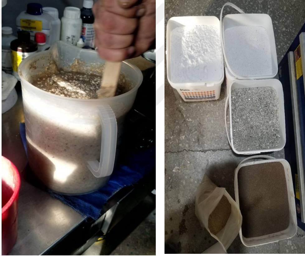
Şekil 4.1. Kayıp önleyici çamurun hammaddeleri ve hazırlanışı
