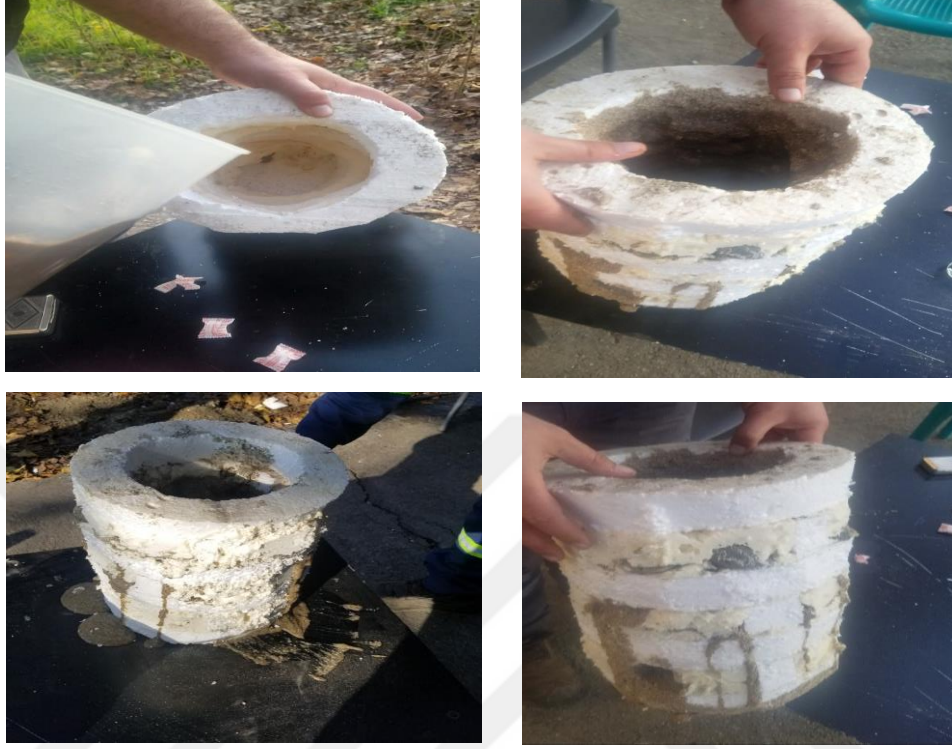
Şekil 4.2. Kayıp önleyici malzeme çamuru kullanılan kuyu örneği
