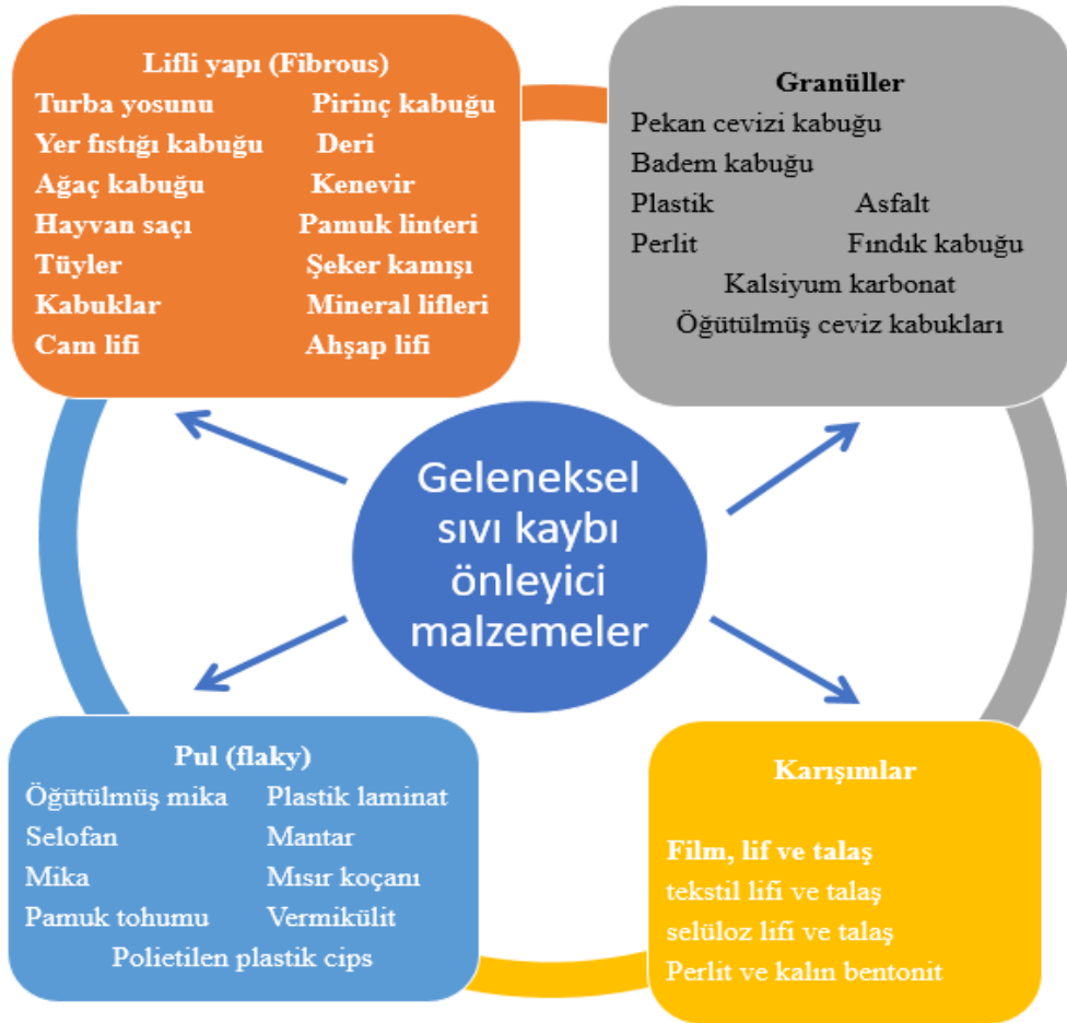
Şekil 2.4. Kayıp önleyici malzemeler için geleneksel sınıflandırma (Jaf ve diğerleri, 2023)
