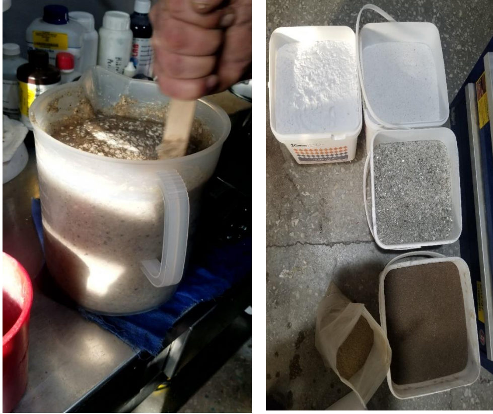
Şekil 4.1. Kayıp önleyici çamurun hammaddeleri ve hazırlanışı
