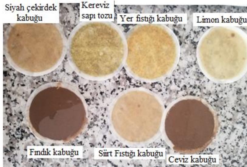
Şekil 5.17. Kayıp önleyici olarak eklenen farklı maddelerde oluşan filtre keklerinin görüntüleri
