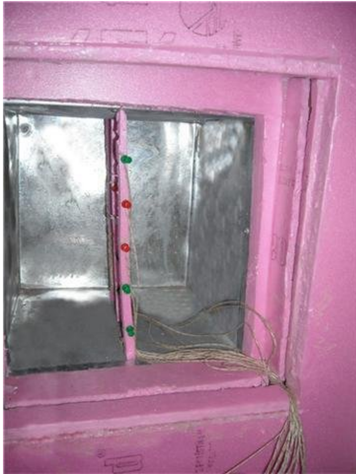
Şekil 2.8. Termoelemanların yerleştirilme şekli
