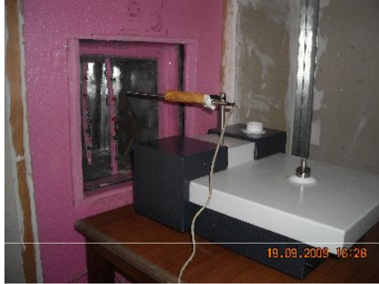
Şekil 2.3. Hız probunun hareket etmesini sağlayan robot
