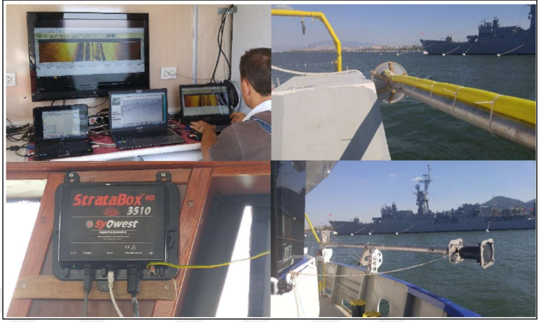
Şekil 4.2 Stratabox sığ sismik mühendislik sistemi (Kişisel arşiv, 2018)
