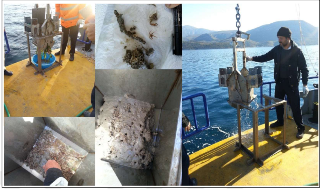
Şekil 4.3 Box corer sediment örnekleme sistemi ve biyolojik örnekler (Kişisel arşiv, 2018)
