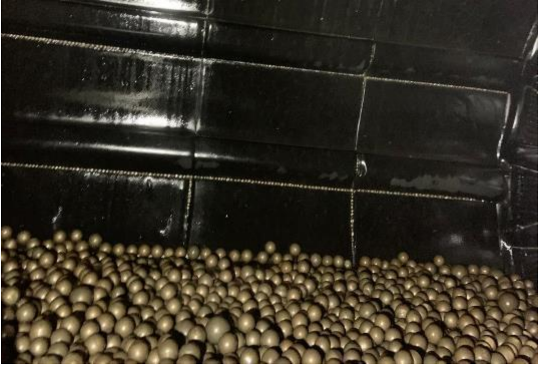
Şekil 8. Bilyeli maden değirmeninin içi; bilyeler , kauçuk astar ve lifterbarlar
