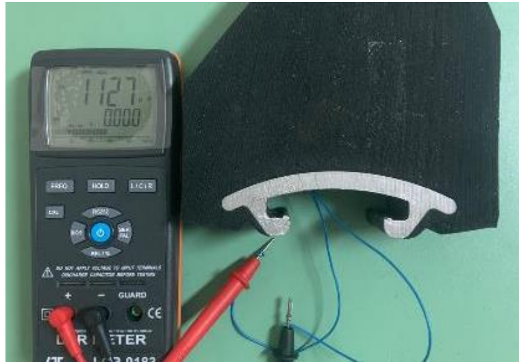
Şekil 49. RCL metre ile kapasitif prob ölçümü yapılmakta olan lifterbar
