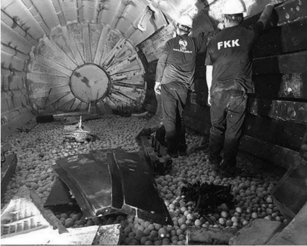
Şekil 10: Kauçuk lifterbar değişimi yapılan bilyeli bir değirmen (Altuncu, ve diğerleri, 2022).
