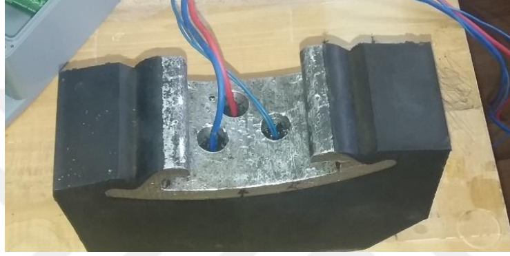
Şekil 47. Rezistif proplar ve kapasitif prop eklenmiş test edilecek lifterbar parçası
