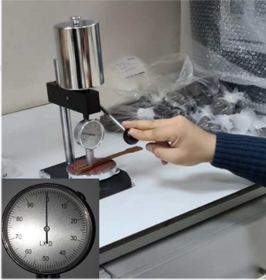
Şekil 2.18. Ceast sertlik ölçüm cihazı ve test sırasındaki görüntüsü
