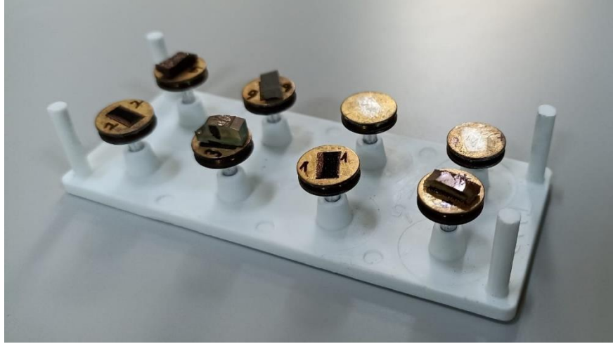
Şekil 3.54. Numune yüzeylerinin altın kaplanmış görüntüsü
