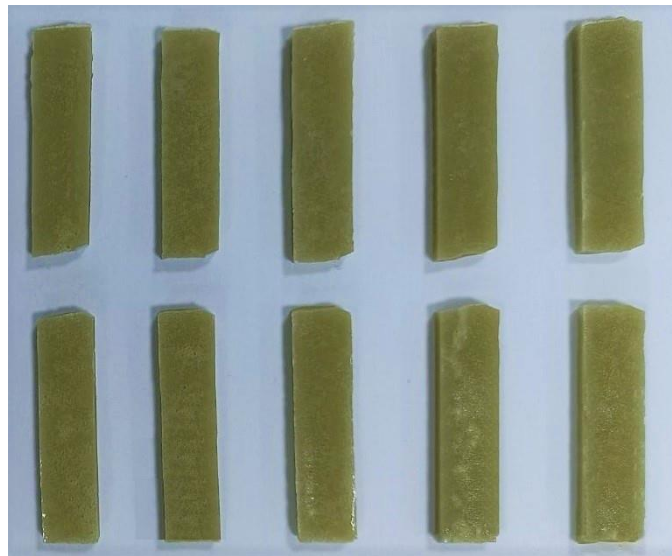
Şekil 3.47. E70TK30 numunelerine ait kırılma şekilleri
