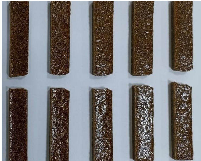
Şekil 3.41. E60CK40 numunelerine ait kırılma şekilleri
