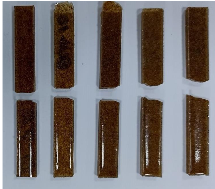
Şekil 3.37. E80CK20 numunelerine ait kırılma şekilleri
