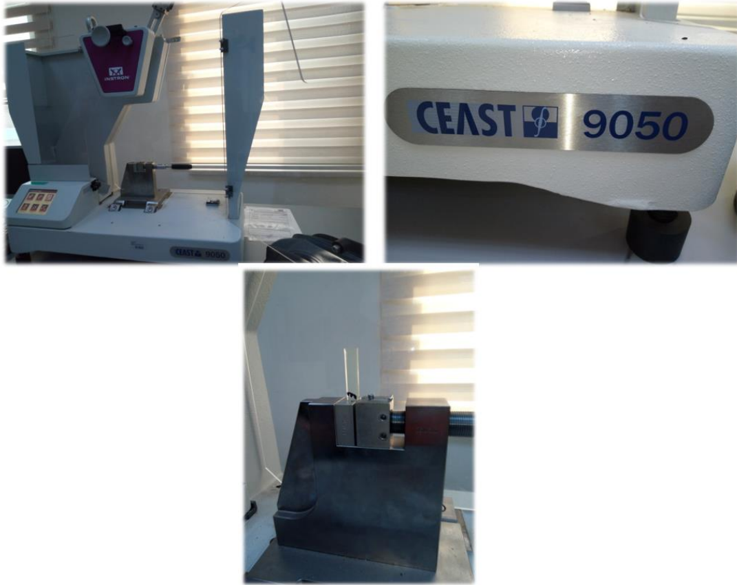
Şekil 2.14. Ceast 9050 marka izod test cihazı ve darbe testi sırasındaki görüntüsü
