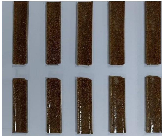
Şekil 3.51. E69CK30CU1 numunelerine ait kırılma şekilleri
