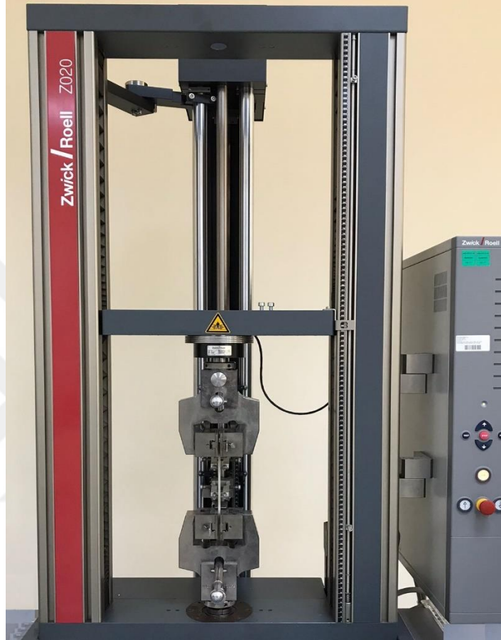
Şekil 2.13. Zwick/Roell Z020 marka test cihazı ve üç nokta eğme testi için kullanılan makina
