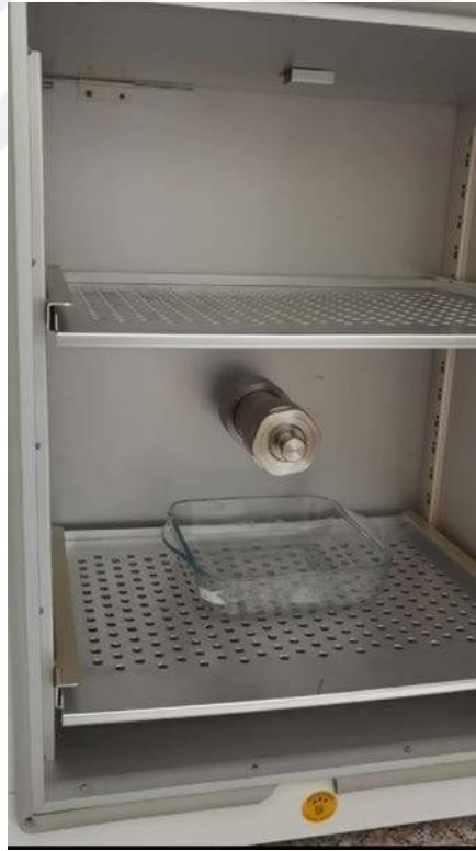
Resim 3.1 Etüv içinde dönerek hidrotermal reaktör ile kullanılabilen sistem
