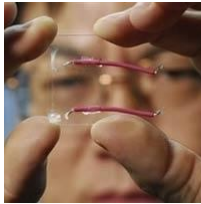
Resim1.2 Nano teknoloji ile üretilen piezoelektrik malzeme (İnt. Kyn.2).
