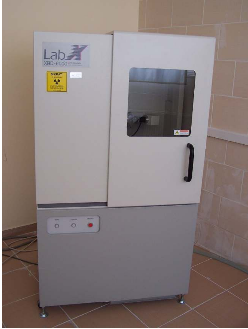
Resim 3.3 Shimadzu XRD-6000 markalı XRD
