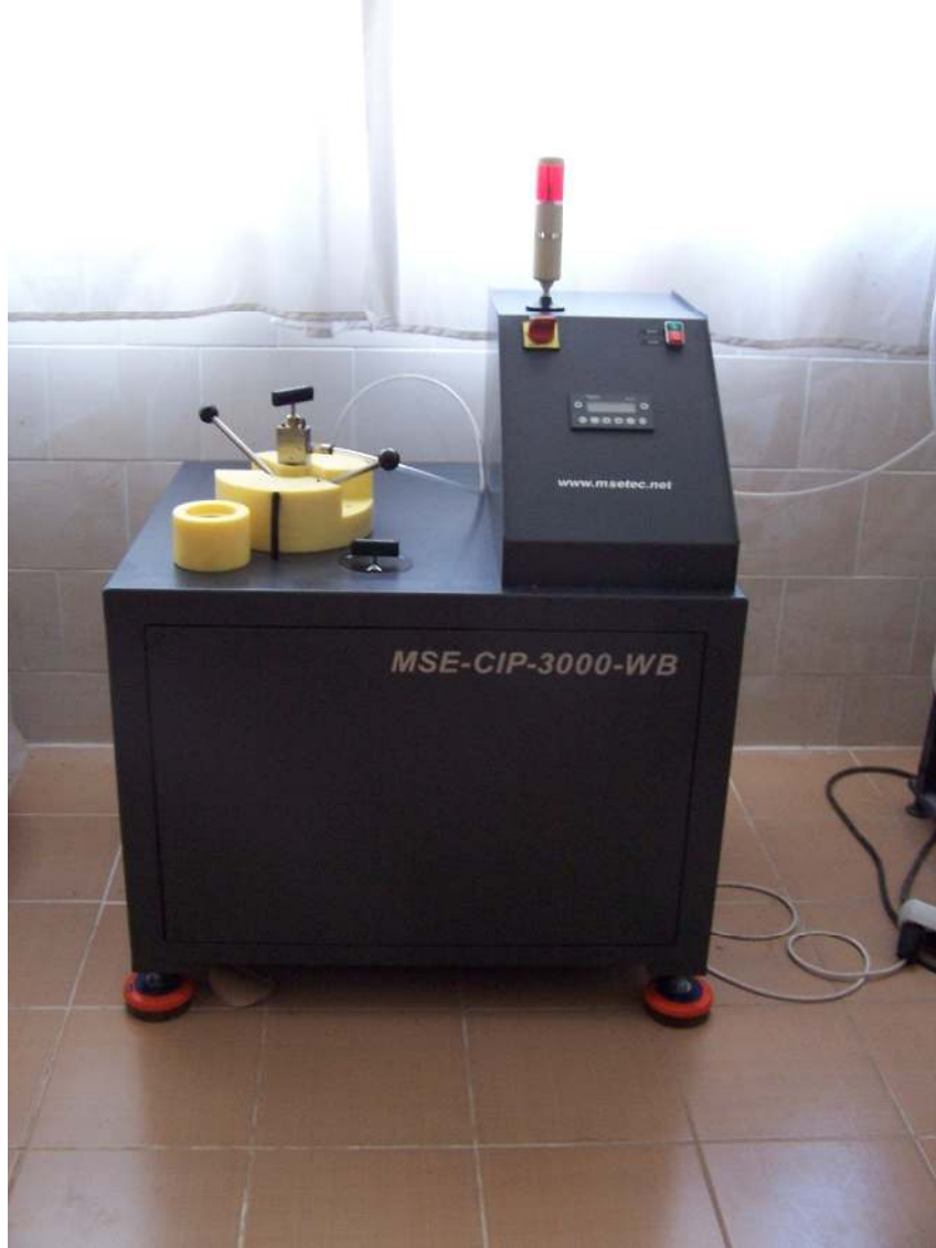
Resim 3.2 MSE-CIP-3000-WB markalı soğuk izostatik pres
