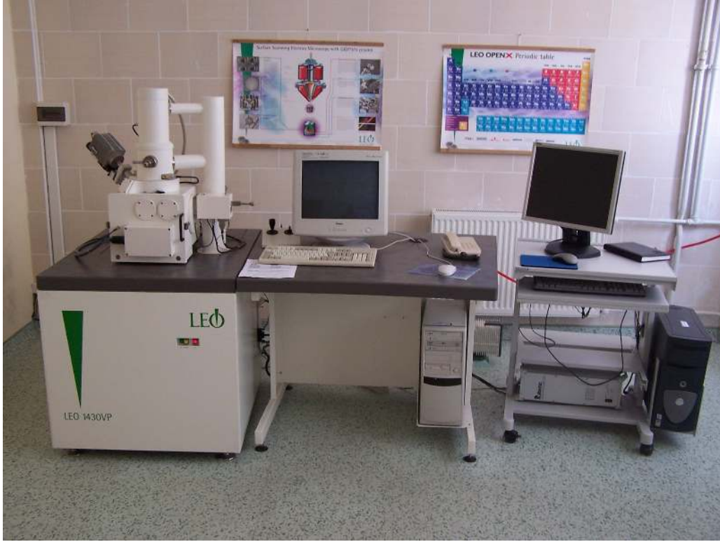
Resim 3.4 LEO 1430vp markalı SEM
