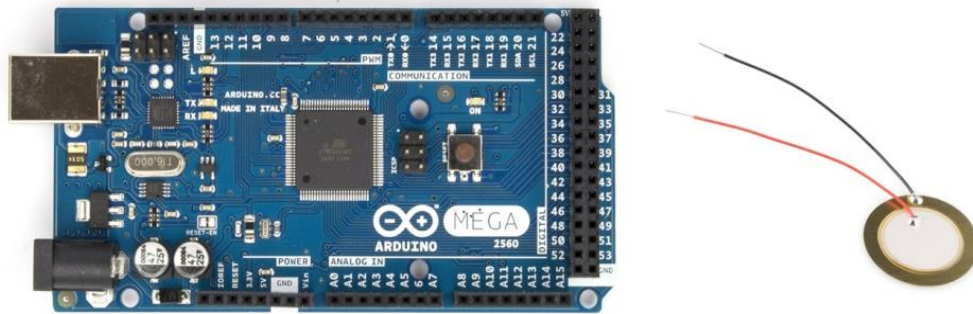
Figure 5.5 : (a) Arduino Mega (URL-1) (b) Piezoelectric sensor (URL-2).
