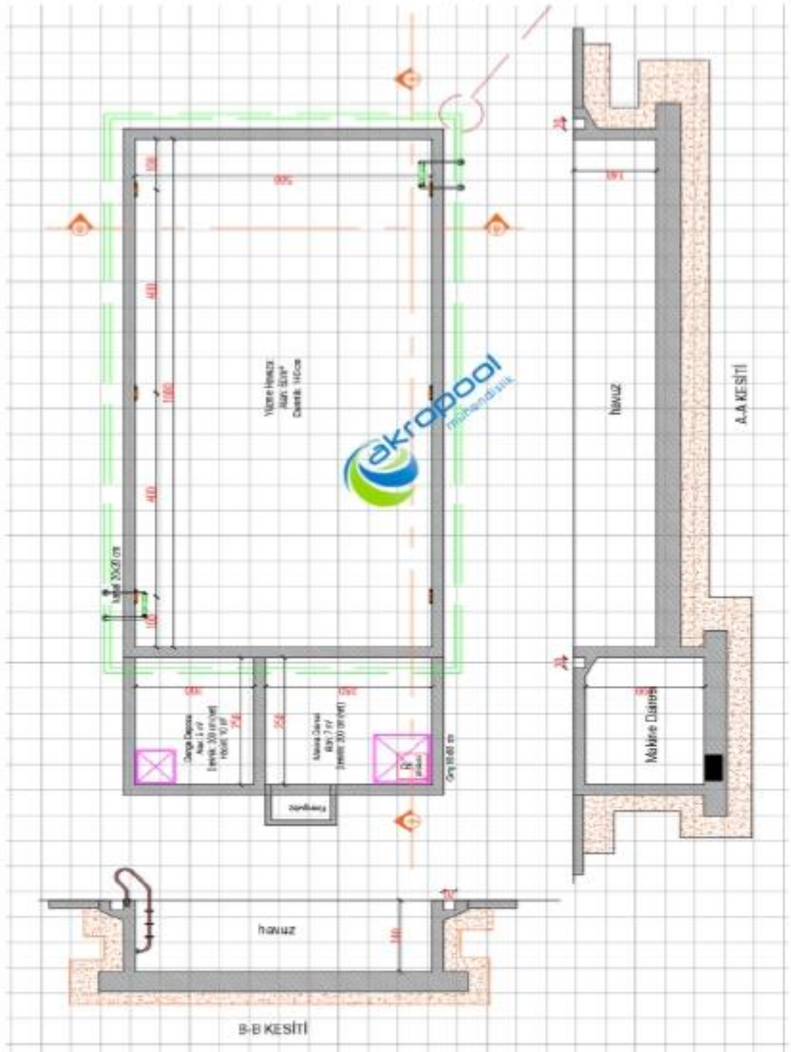
Şekil 4.3. Site Kapalı yüzme havuzu havuz planları
