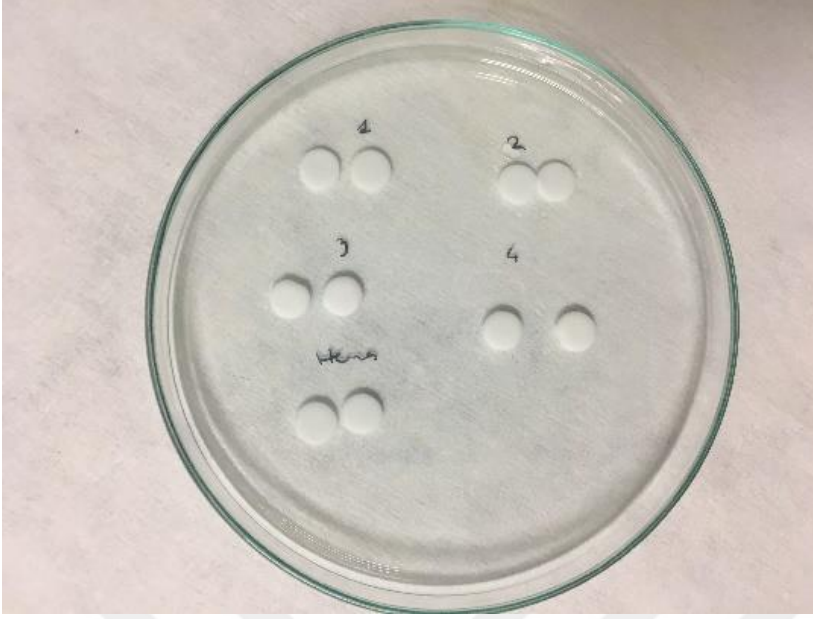
Şekil 4.2. Farklı kompleks oranlarında moleküler baskılanmış/baskılanmamış kriyojeller
