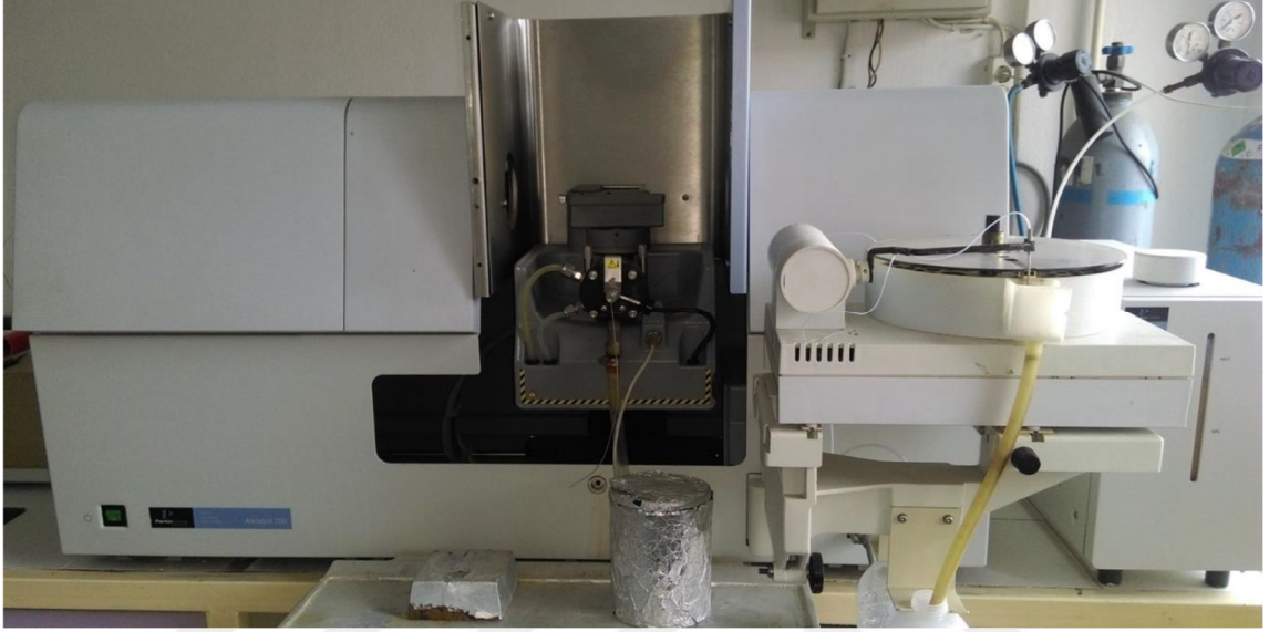
Şekil 3.1. Alevli atomik absorpsiyon cihazı (FAAS ) (Demirok, 2019)
