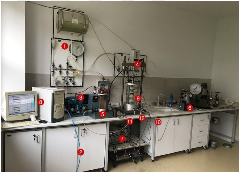
Şekil 3.13. Üç eksenli basınç deney sistemi (CTX).
