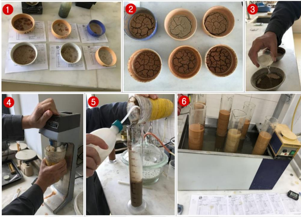
Şekil 3.8. Hidrometre deneyi yapım aşamaları.
