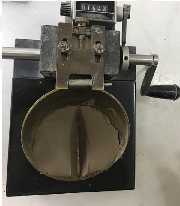
Şekil 3.2. Casagrande yöntemiyle likit limit deneyi.
