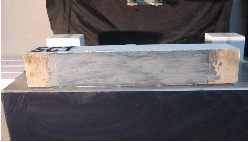
Resim 4.6. CFRP yapıştırılmış deney elemanı
