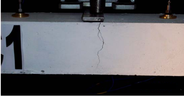
Resim 5.1. SC1 Elemanında oluşan ilk hasar
