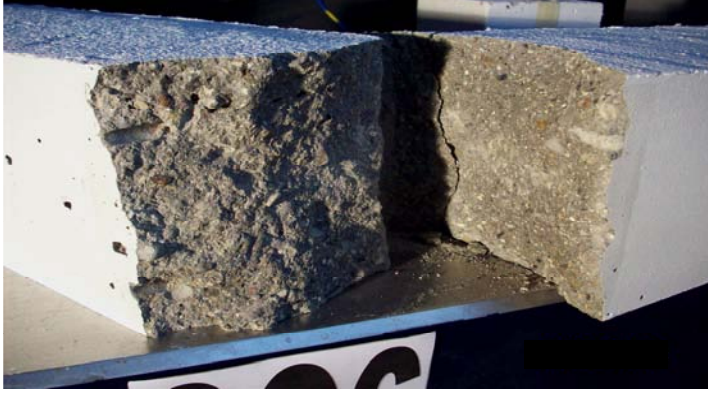
Resim 5.23. SC6 Elemanının agrega-matris görünümü
