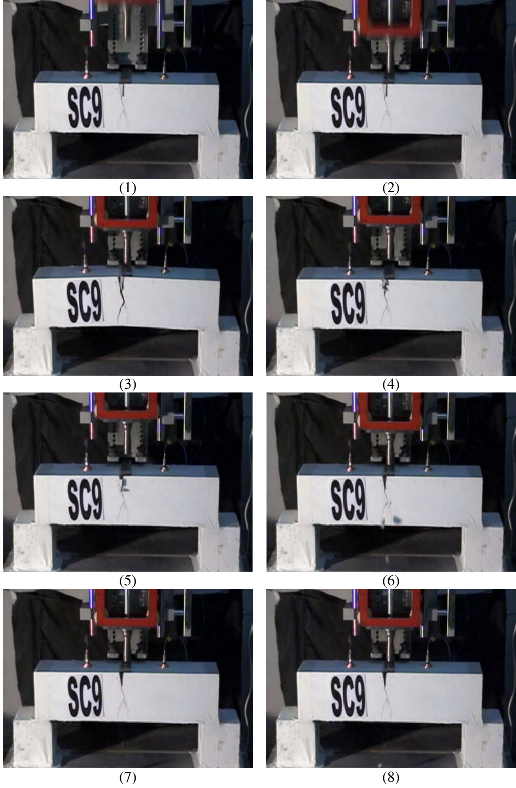
Resim 5.36. SC9 Deney elemanı göçme durumu
