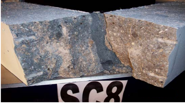
Resim 5.31. SC8 Elemanının agrega-matris görünümü
