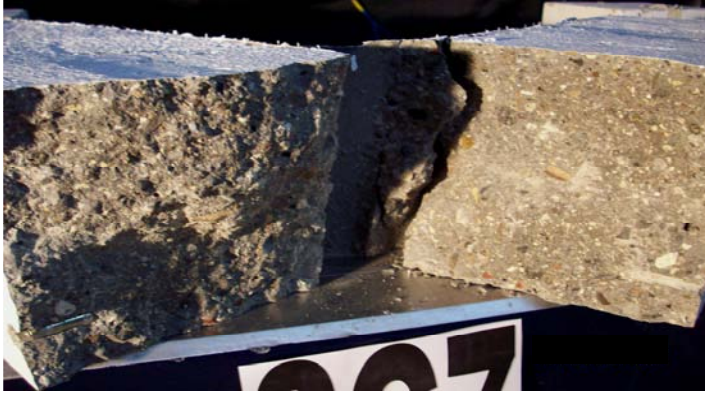
Resim 5.27. SC7 Elemanının agrega-matris görünümü
