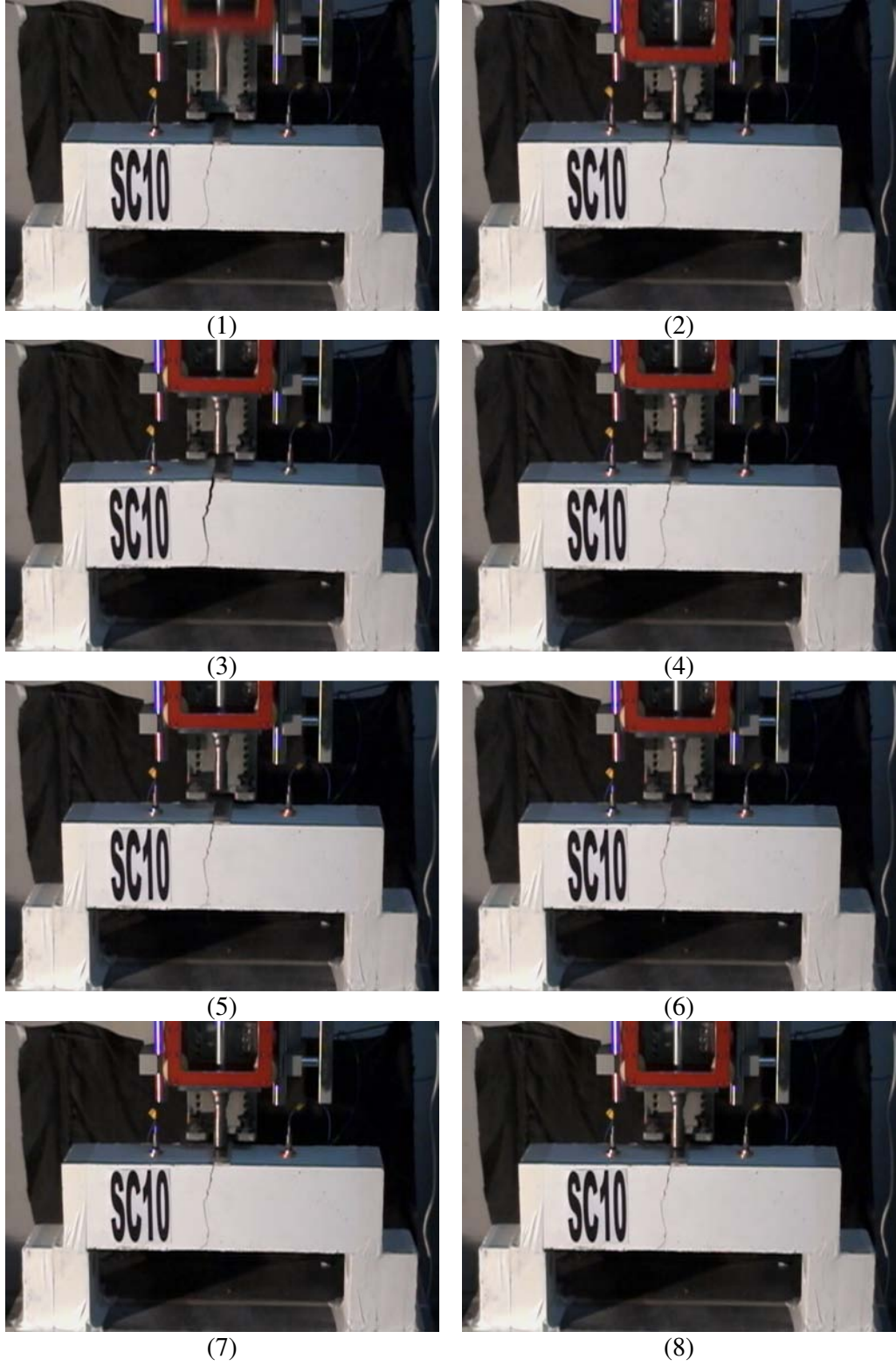
Resim 5.40. SC10 Deney elemanı göçme durumu
