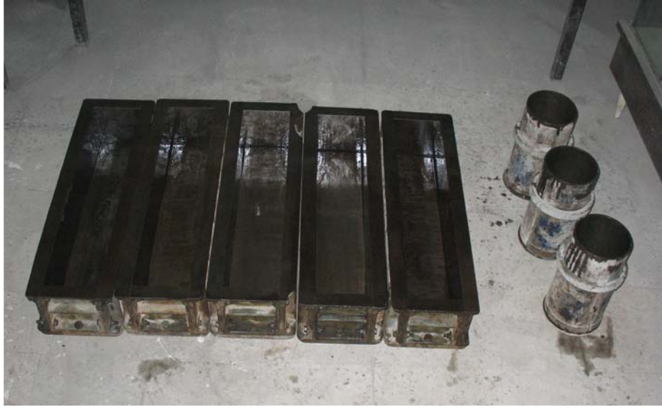
Resim 4.3. Deney elemanlarının hazırlandığı döküm metal kalıplar
