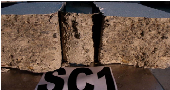
Resim 5.3. SC1 Elemanının agrega-matris görünümü
