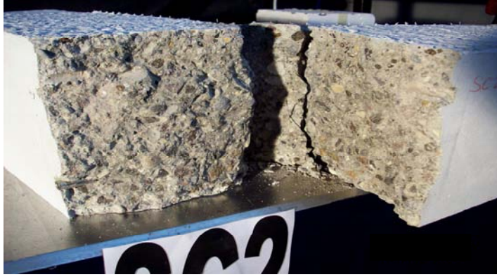
Resim 5.7. SC2 Elemanının agrega-matris görünümü
