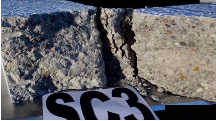
Resim 5.11. SC3 Elemanının agrega-matris görünümü
