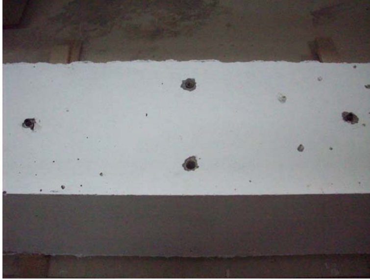
Resim 4.4. Deney elemanı üzerine açılan delikler
