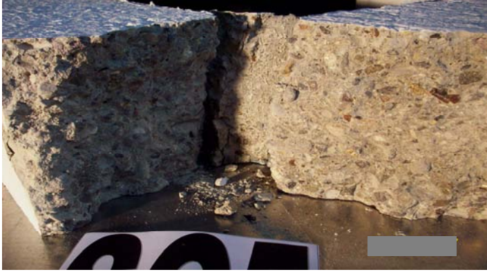
Resim 5.19. SC5 Elemanının agrega-matris görünümü
