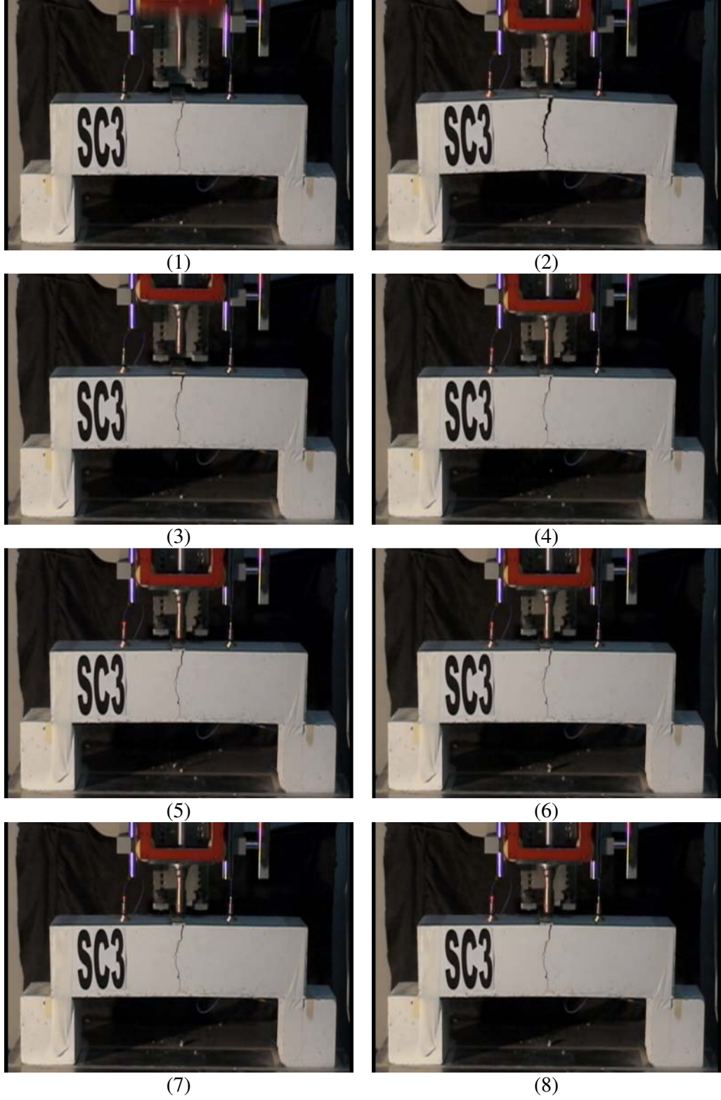
Resim 5.12. SC3 Deney elemanı göçme durumu
