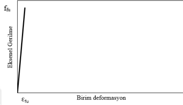
Şekil 3.3. FRP malzemesinin gerilme-birim deformasyon ilişkisi
