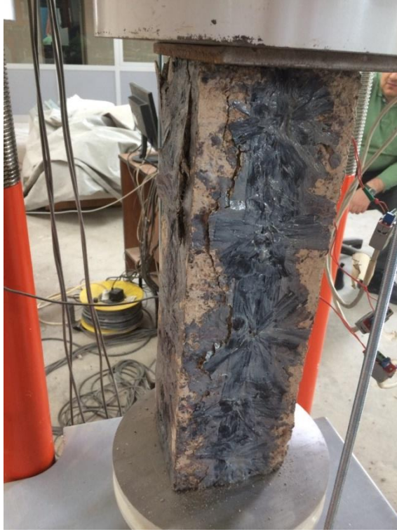
Şekil 4.32. Deney elemanı -11 üst ucunda betonda ezilmesi.
