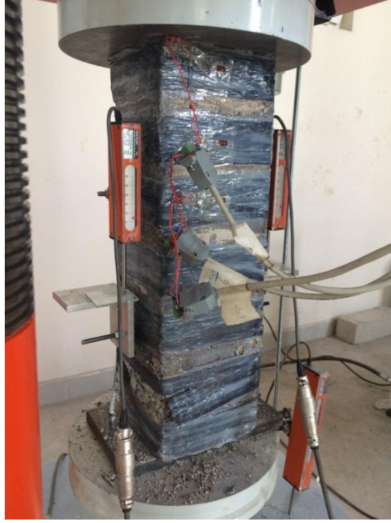
Şekil 4.11. Deney elemanı -4 alt ucunda betonda ezilme.
