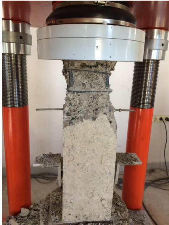
Şekil 4.3. Deney elemanı-1 boyuna donatılarının burkulması ve göçmesi.
