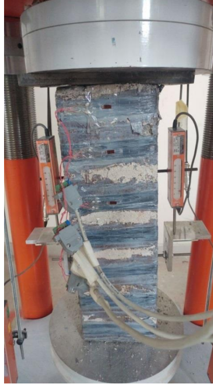
Şekil 4.23. Deney elemanı-8 üst ucunda betonda ezilme.
