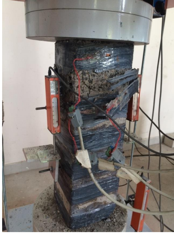
Şekil 4.26. Deney elemanı -9 üst ucunda betonda ezilmesi.
