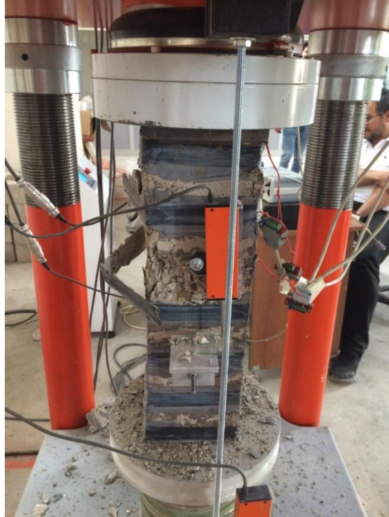
Şekil 4.9. Deney elemanı-3 üst ucundaki CFRP şeritlerin kopması sonucunda göçmesi.
