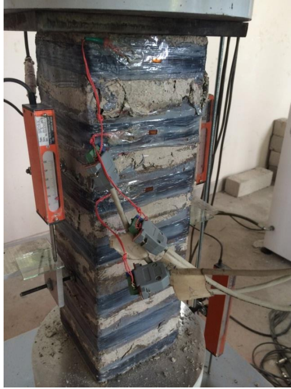
Şekil 4.8. Deney elemanı -3 üst ucunda betonda ezilme.
