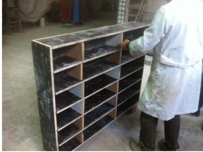
Şekil 3.13. Deney elemanlarının dökülmesinden kullanılan kalıp sistemi.
