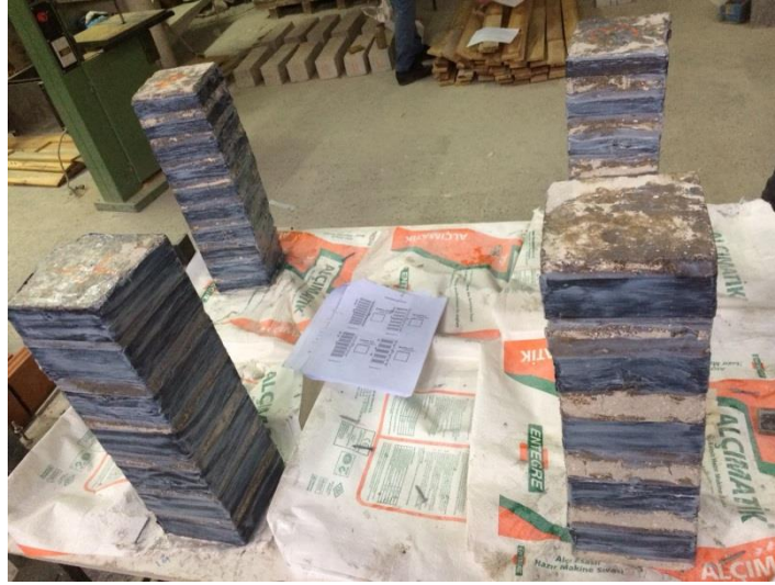
Şekil 3.21. CFRP yapıştırma işlemi tamamlanmış deney elemanları.
