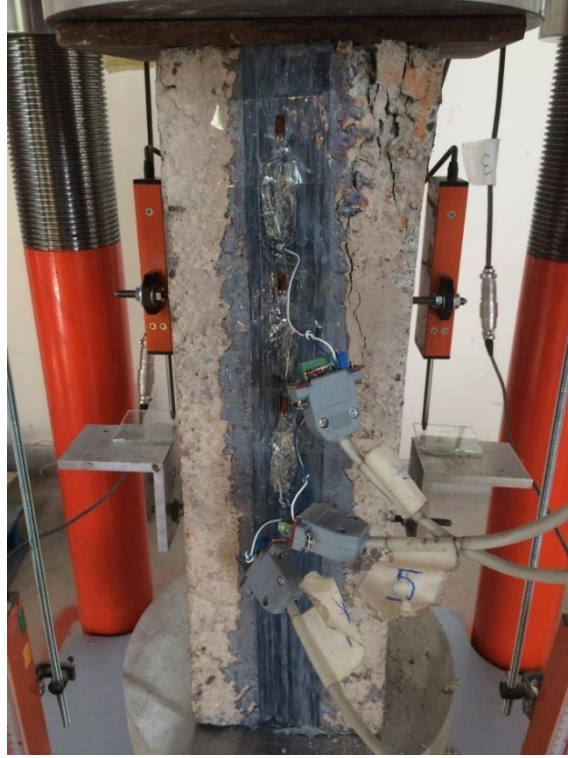
Şekil 4.17. Deney elemanı -6 üst ucunda betonda ezilmesi.
