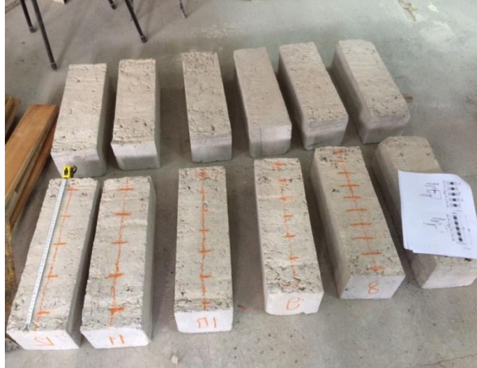
Şekil 3.20. CFRP yapışma yüzeylerinin temizlenmesi ve işaretlenerek hazırlanması.
