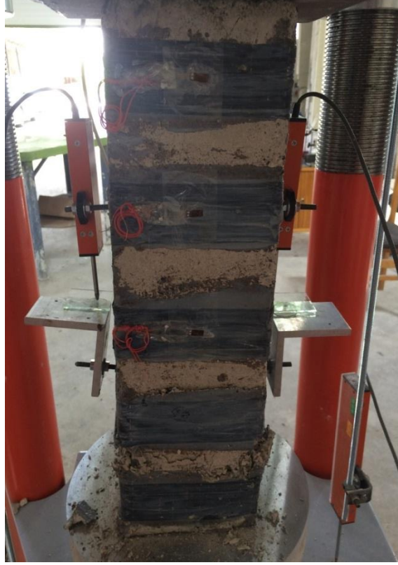
Şekil 4.14. Deney elemanı -5 alt ucunda betonda ezilme.
