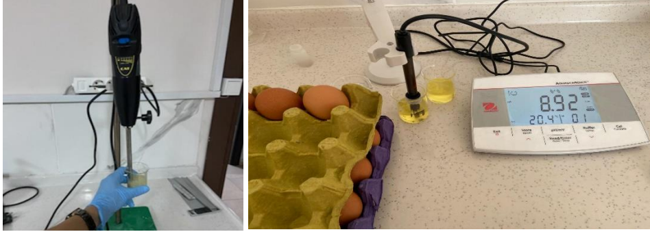
Resim 3.4. Yumurta akının homojenize edilmesi ve pH'sının ölçülmesi
