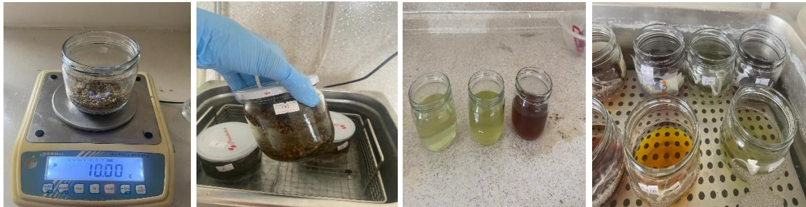
Resim 3.1. Lavanta distilasyon katı atığı ekstraksiyonu
