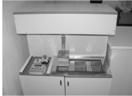
Resim 15 Termalsiklus prosedürü için kullanılan elektronik termalsiklus cihazı (Koyutürk’den, 185)
