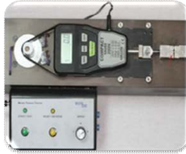
Resim 19 Mikro-gerilme test tekniği için kullanılan universal test cihazı.
