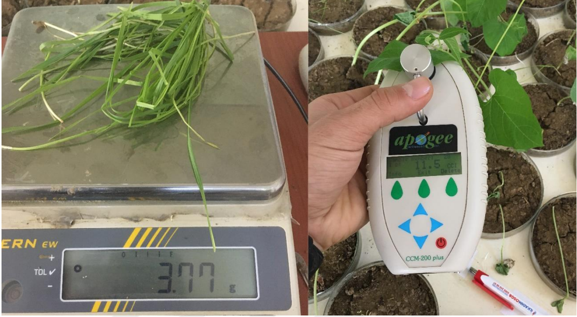
Şekil 3.6. Test bitkisi yaş ağırlığı tartımı ve klorofil değerlerinin belirlenmesi
