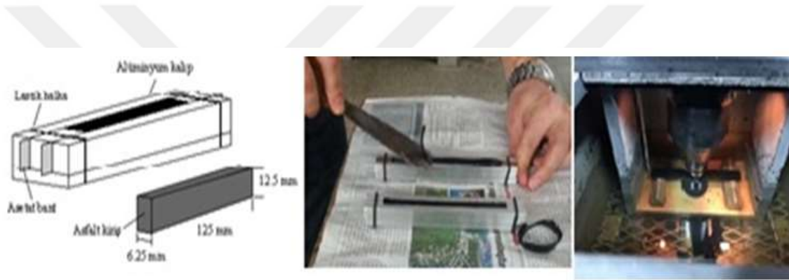
Şekil 3.10. BBR numuneleri ve deney düzeneği
