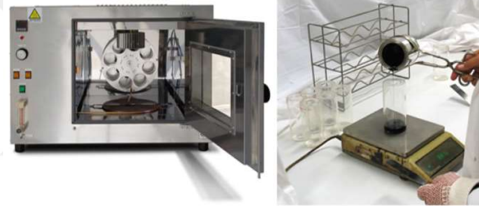
Şekil 3.6. RTFOT deney cihazı ve şişeleri
