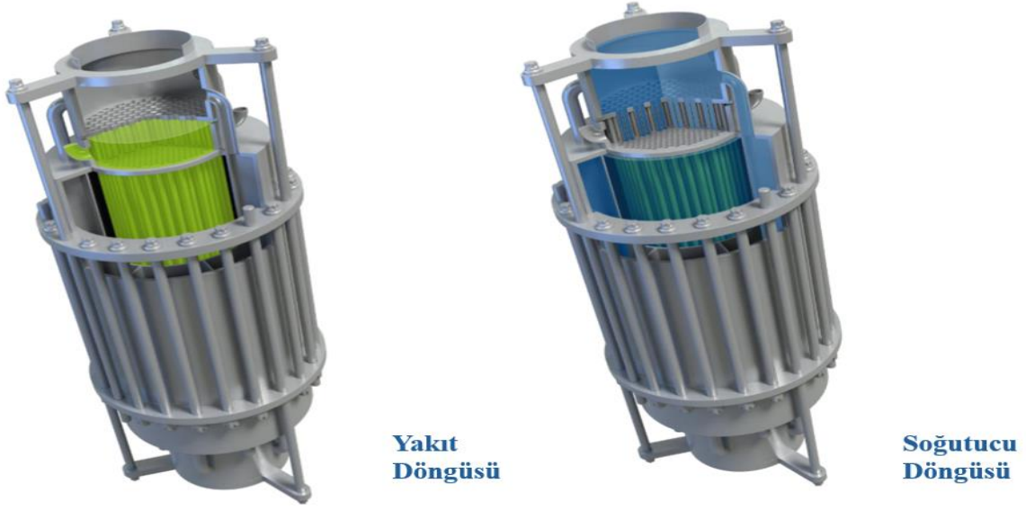
Şekil 2.1 DFR-600M tasarımında yakıt ve soğutucu döngüsü (Dual fluid, 2022).
