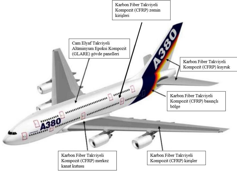
Şekil 1.2. Airbus A380 uçaęında CFRP kullanılan yapısal parçalar (Wanhill, 2018)
