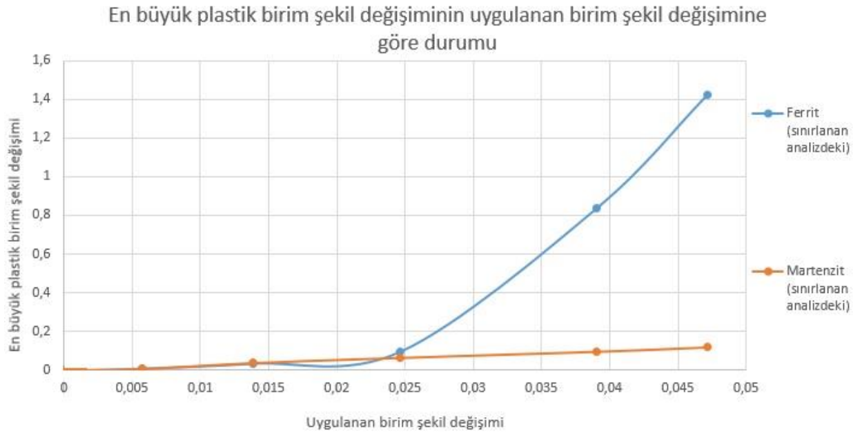
Şekil 4.8: En büyük plastik birim şekil değişiminin uygulanan birim şekil değişimine göre durumu
