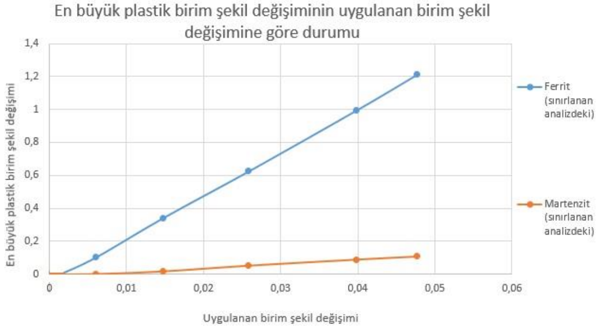
Şekil 4.4: En büyük plastik birim şekil değişiminin uygulanan birim şekil değişimine göre durumu
