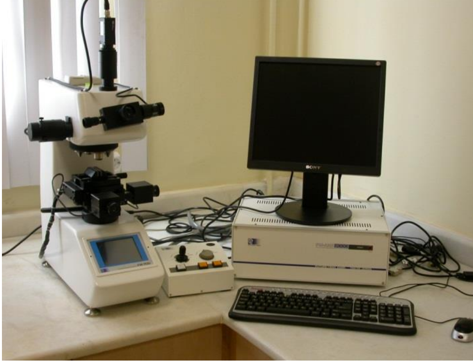
Şekil 3. 6 Deneyde kullanılan Nikon Epiphot 200 marka optik mikroskop
