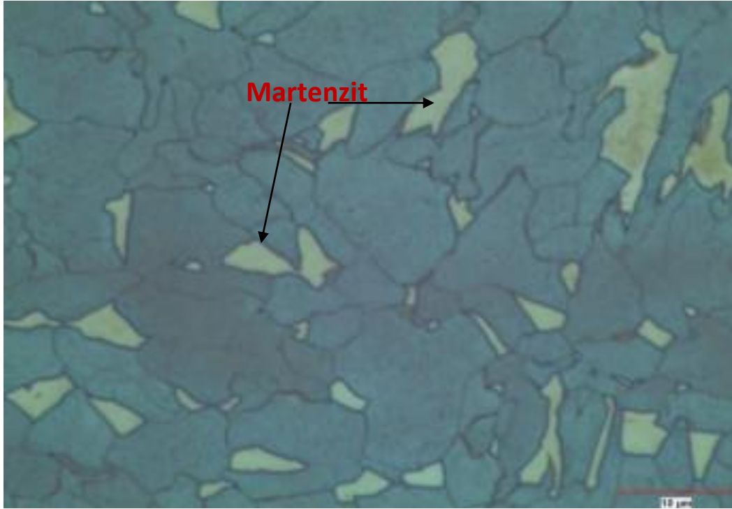
Şekil 4. 5 G bölgesi mikroyapı görüntüsü X1000 büyütme, MHO % 13 (Sıcaklık 312 °C)
