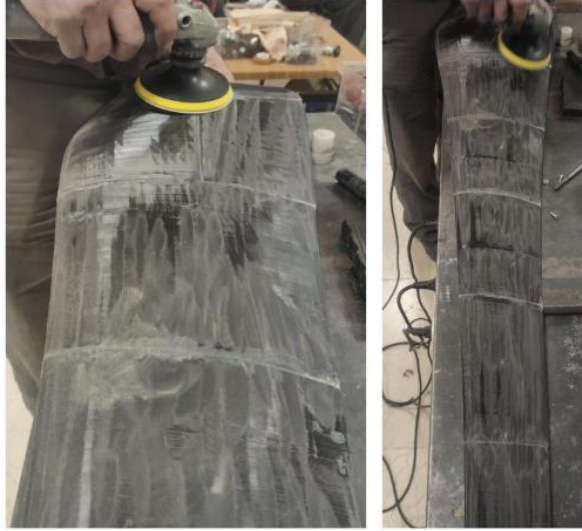
Fotoğraf 2.12. Model yüzey hazırlama işlemleri-Zımparalama
