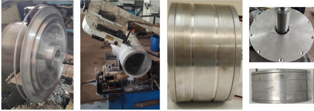
Fotoğraf 2.17. Alternatör gövde imalatı aşamaları ve imalat sonrası görüntüler
