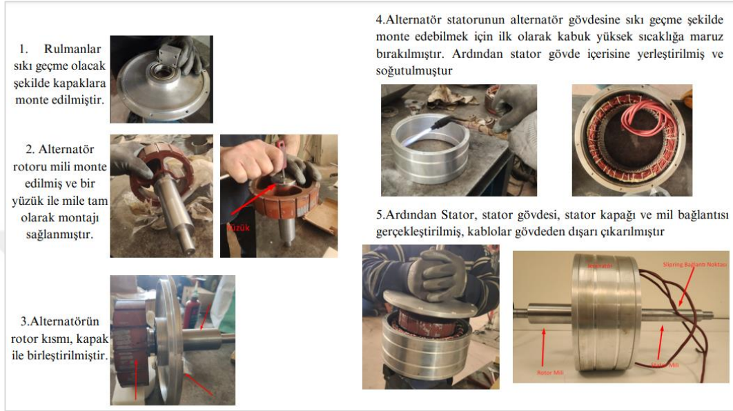
Fotoğraf 2.18. Alternatör Montaj Aşamaları
