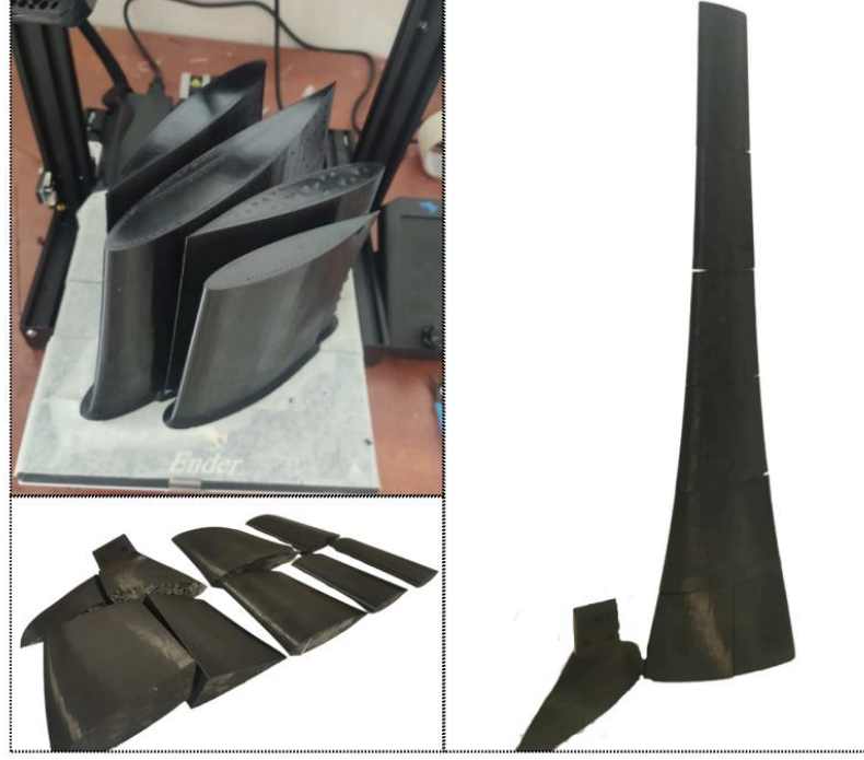
Fotoğraf 2.10. Kanat modeli için 3D baskı ile alınan kanat parçaları
