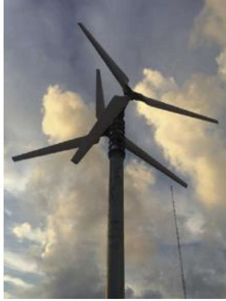
Fotoğraf 1.8. Cho ve ark. (2017) tarafından çalışmalarında kullanılan çift rotorlu rüzgâr türbini tasarımı
