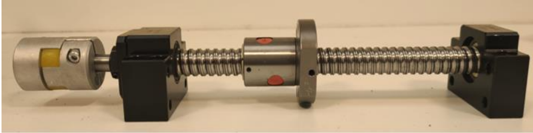
Fotoğraf 2.19. Vidalı mil bağlantısı imalat ve montaj sonrası görseli
